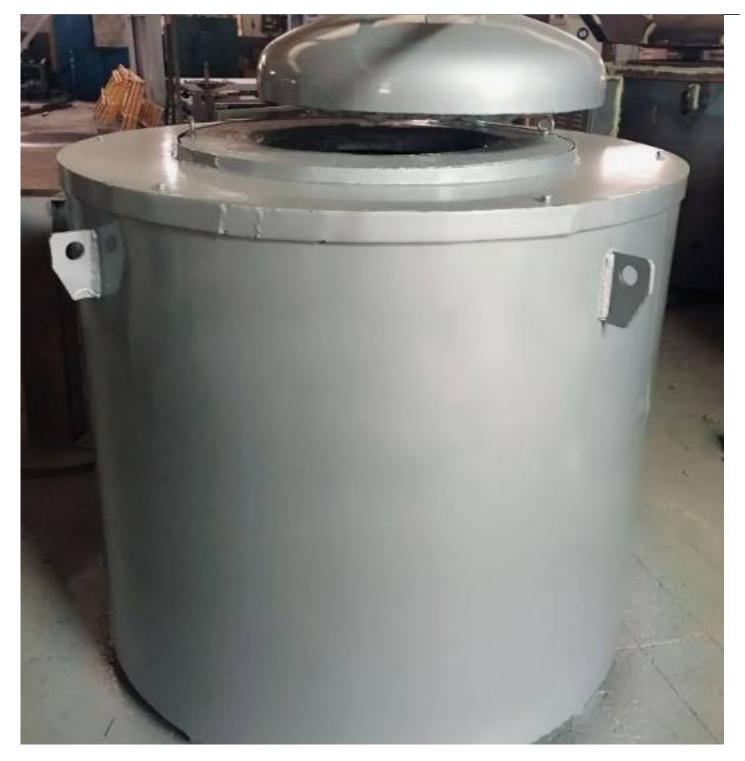
自动喷流恒温熔锡炉的基本原理是利用电能将炉子的加热元件(如电阻丝)加热到一定温度,然后通过吹送或喷流的形式将热空气或氮气送入炉内,以达到加热和保温的目的。与传统熔炼方式相比,自动喷流恒温熔锡炉具有以下几个显著优势:
