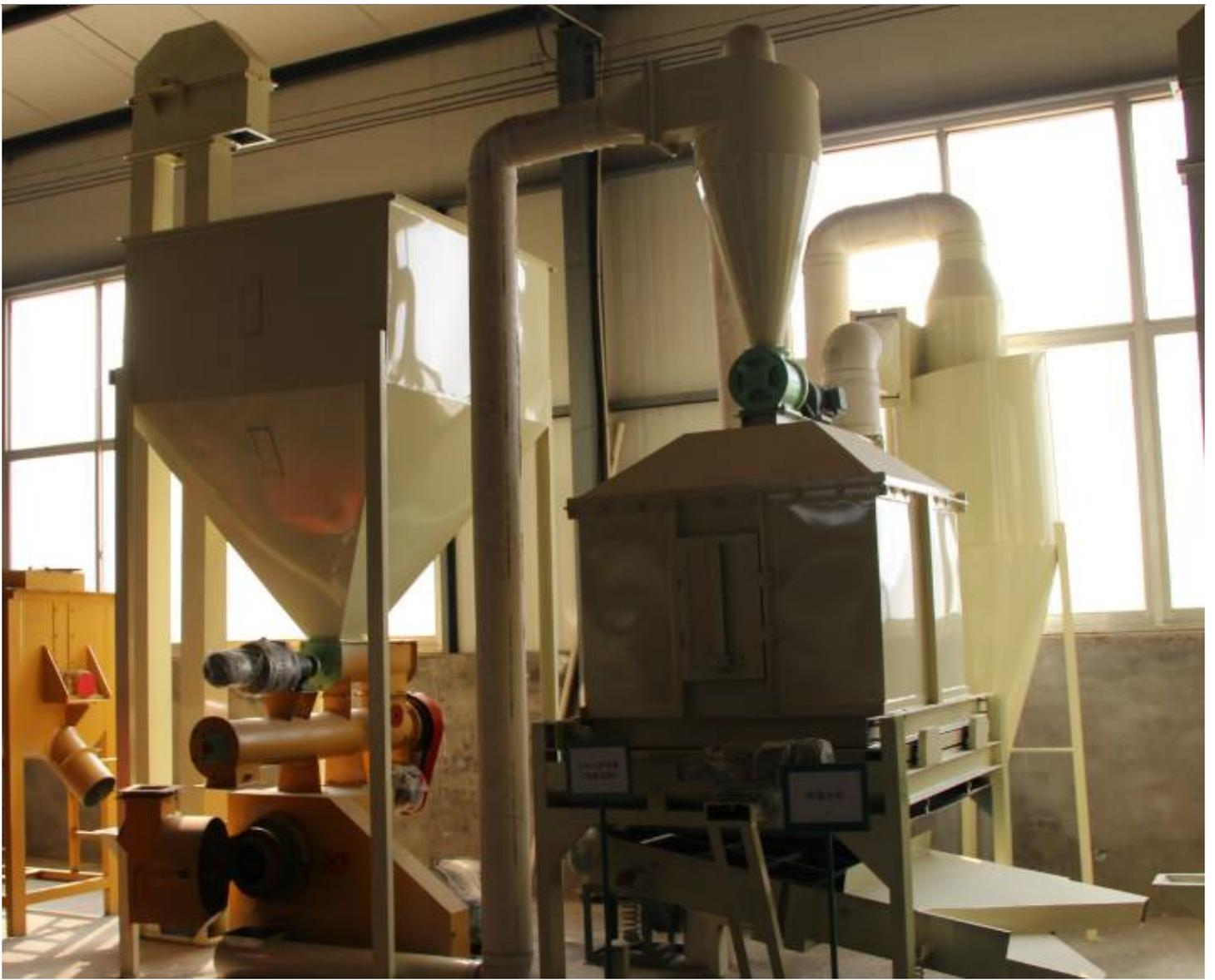
其中，鱼饲料机械是一种专门用于鱼类饲料加工的设备。它主要由进料装置、破碎装置、搅拌装置和造粒装置组成。鱼饲料机械的主要作用是将各种原料加工成适合鱼类摄食和消化吸收的颗粒饲料。鱼饲料机械不仅可以大幅度提高饲料的利用率，还可以增加饲料的营养成分，提高鱼类的生长速度和免疫力。
