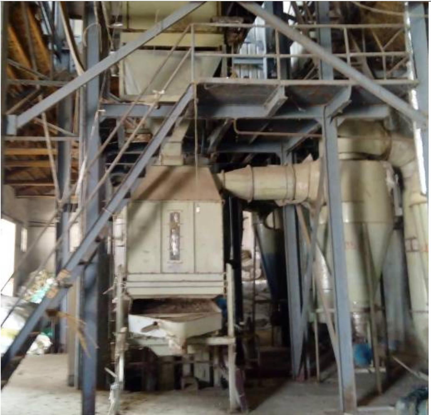
玉米芯饲料加工设备是一种专门用于将玉米芯进行加工的设备。玉米芯富含淀粉和纤维素，是一种理想的饲料原料。然而，由于其外层较硬，不易被动物消化吸收。通过玉米芯饲料加工设备的处理，可以有效的改良玉米芯的饲料价值。首先，玉米芯经过设备的破碎和切碎作用，使其颗粒度适宜，易于动物咀嚼和消化吸收。其次，通过膨化和高温处理，能够破坏玉米芯中的抗营养成分，提高蛋白质的可利用率，增加饲料的营养价值。此外，玉米芯饲料加工设备还能够降低饲料中的微生物、霉菌等有害成分，保证饲料的卫生安全。
