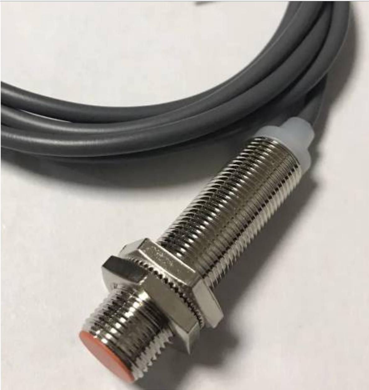
光电开关主要由光源、光敏元件和信号处理电路组成。光源通常采用红外线或激光等光纤，发射出的光被光敏元件接收，经信号处理电路分析处理后，输出一个高低电平信号。当被检测的物体进入光电开关的工作范围时，物体会阻挡或反射光线，从而改变光敏元件的接收状态，通过信号处理，可以实现对物体的检测、计数、分类等功能。
