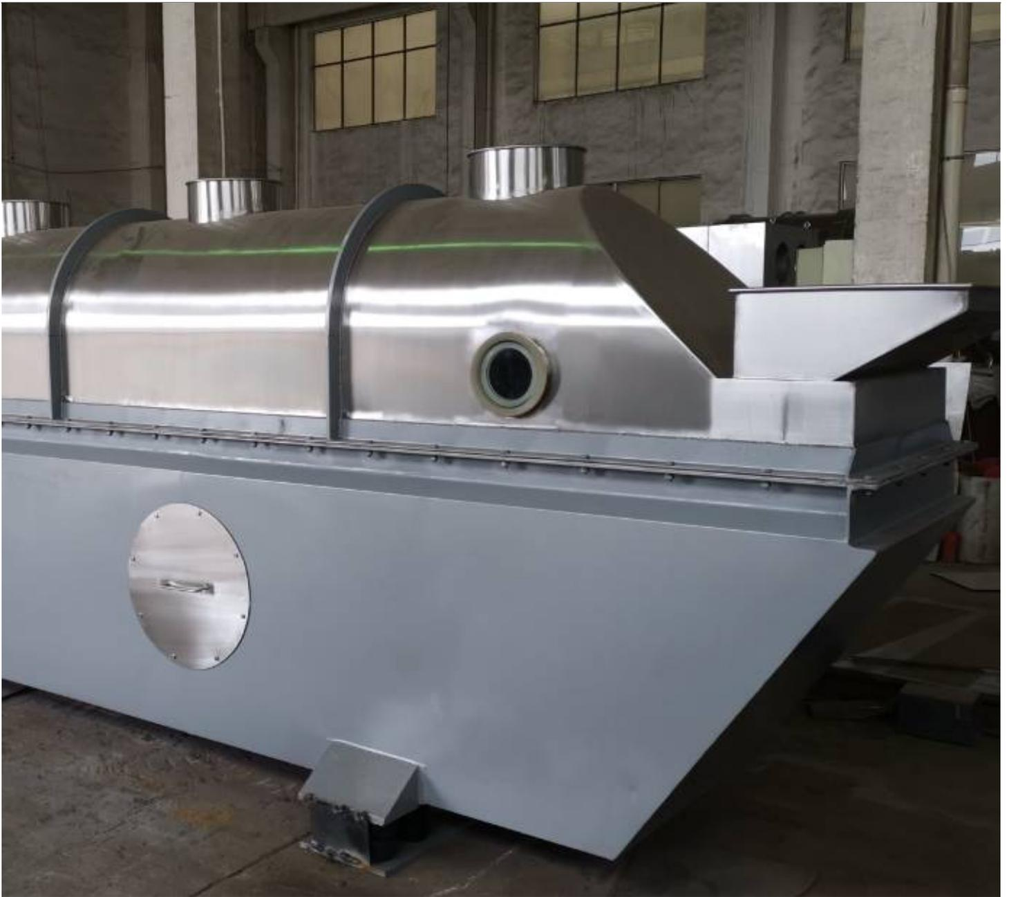
鸡精颗粒烘干机是一种通过热风循环将湿颗粒烘干至理想水分的设备。其工作原理是将湿颗粒通过给定的进料口投放进烘干机内，热风通过加热器产生，并由风机送入机器内部，形成循环流动，不断与湿颗粒接触，使其内部的水分得到蒸发和排除。烘干后的颗粒通过出料口排出，完成整个烘干过程。
