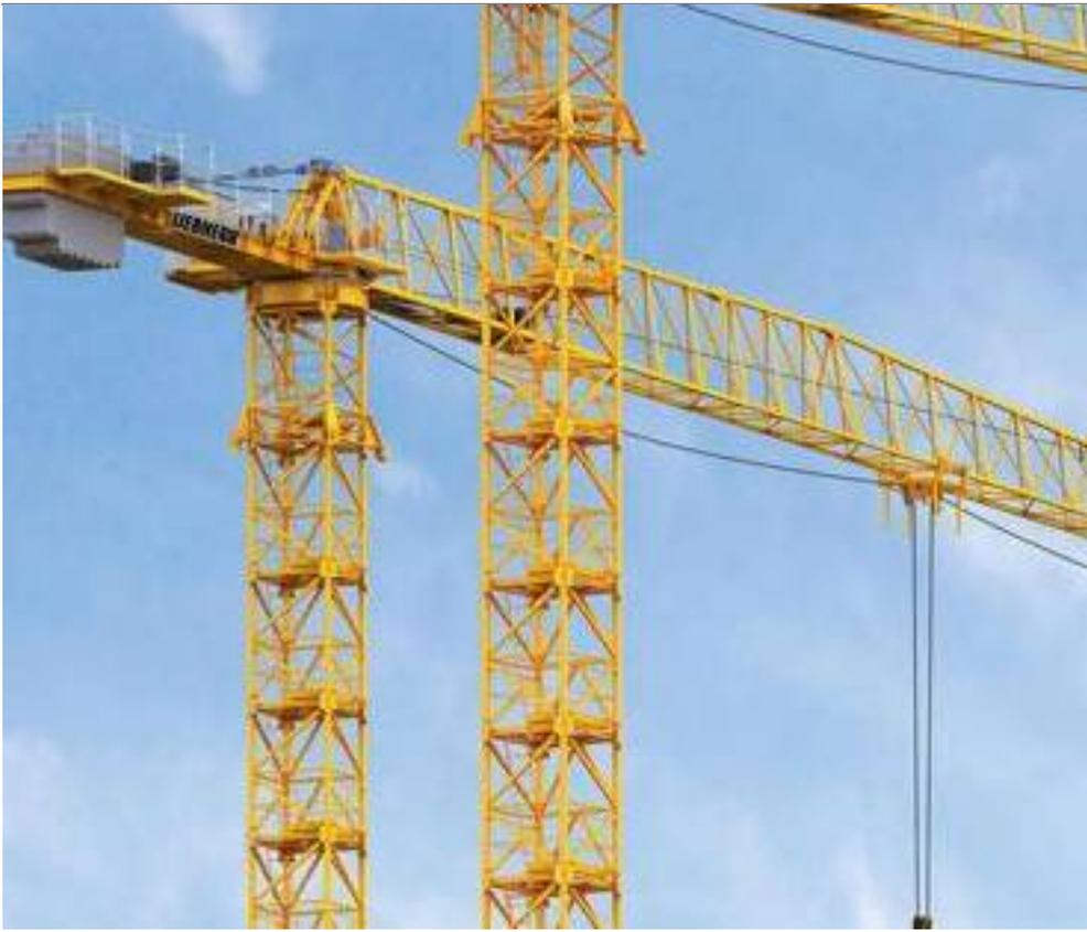
平头塔式起重机由塔身、起重臂、平衡臂、变幅机构、起升机构等组成。塔身是塔式起重机的主体结构，通常采用钢结构，具有很好的抗风能力。起重臂是连接塔身和起重机构的部分，通过变幅机构可以实现起重臂的伸缩。平衡臂的作用是平衡起重臂的重力，以保证起重机构平衡运行。起升机构是平头塔式起重机的核心部件，通过起升机构可以实现货物的上下运输。
