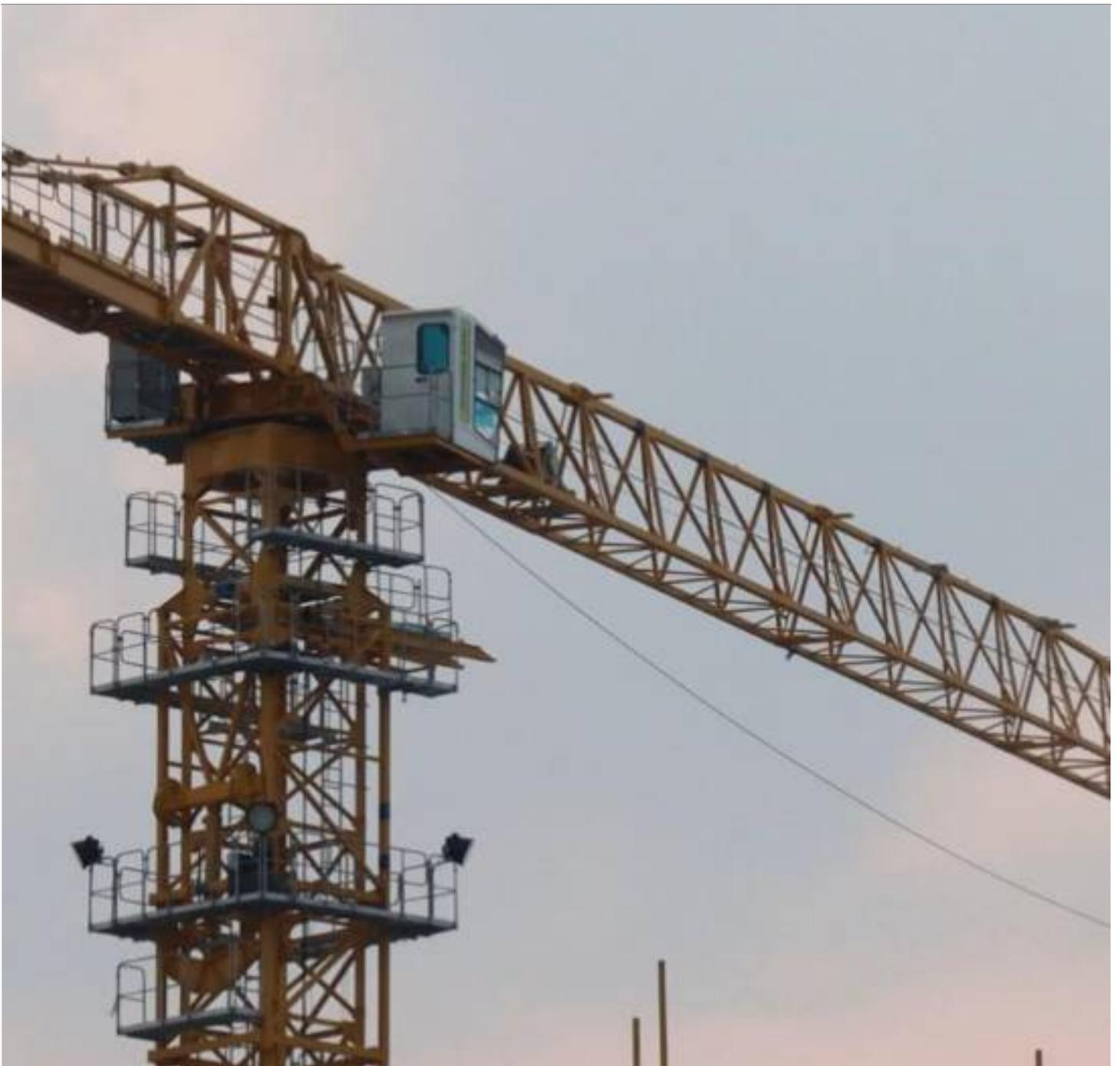
工地用塔吊不仅具备强大的起重能力，还能够实现机械化的运行和操作。它采用电动和液压系统，能够快速、精准地完成各种动作，包括起重、放重、加速和减速等。操作人员可以通过操作室内的控制台，实时监控和控制塔吊的运行，提高工作效率，降低劳动强度。
