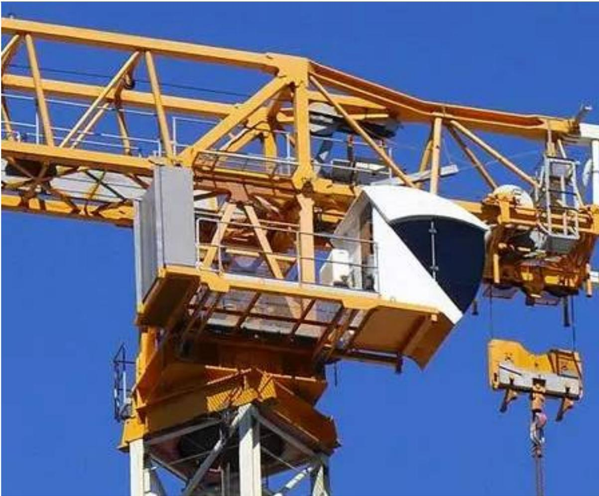
锤头塔式起重机塔吊的工作原理是利用电动机带动液压系统，使得塔吊能够进行各种运动。它具有较大的工作范围和承载能力，在建筑工地上广泛应用。在施工过程中，塔吊可以将重物吊起并移动，将其准确地放置在指定位置上。它可以实现高空物料的运输、安装和拆卸，极大地提高了施工的效率。
