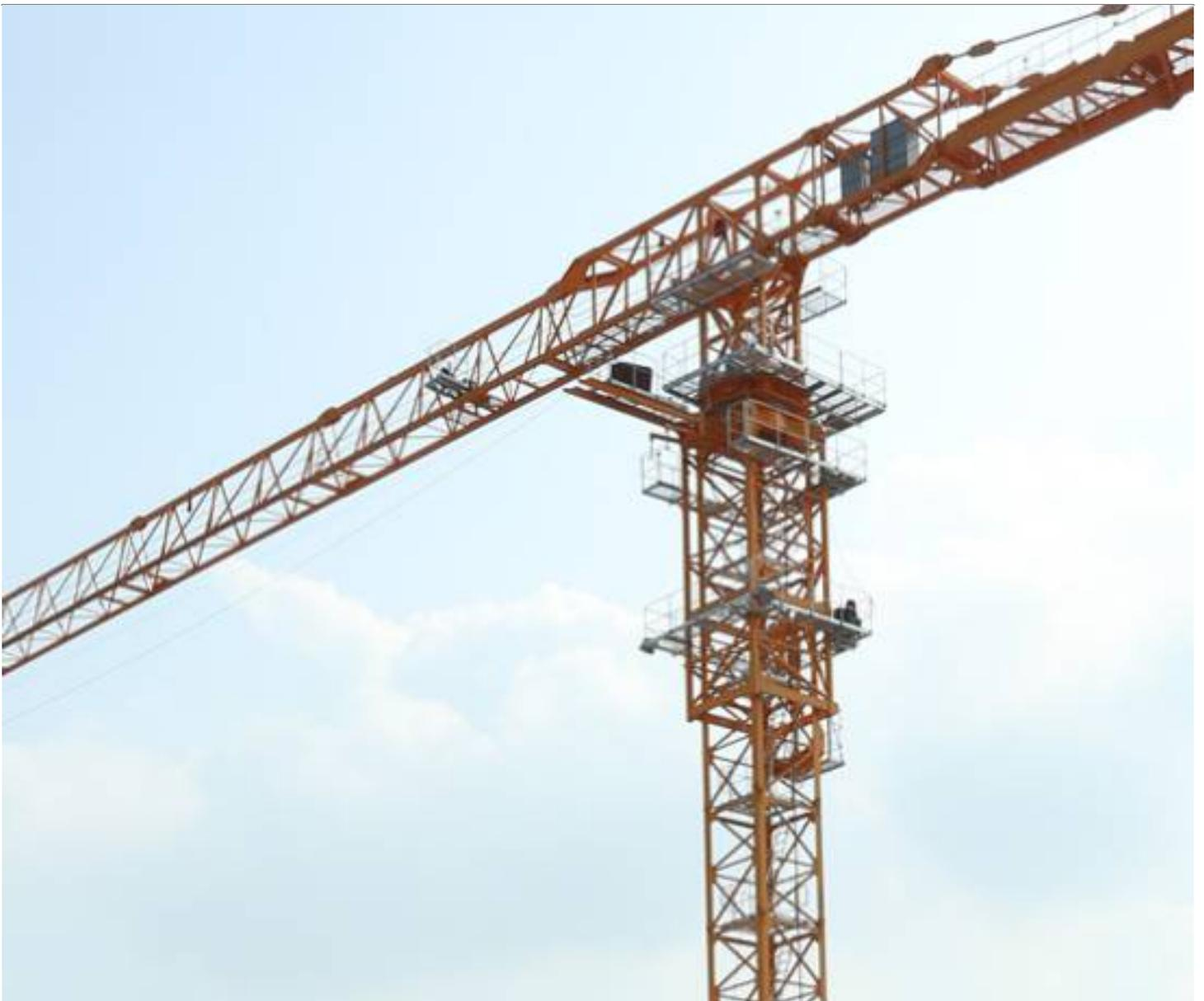
平头塔式起重机是指顶端配有平头（也称为悬臂）的固定式起重机械。它具有以下显著特点：
