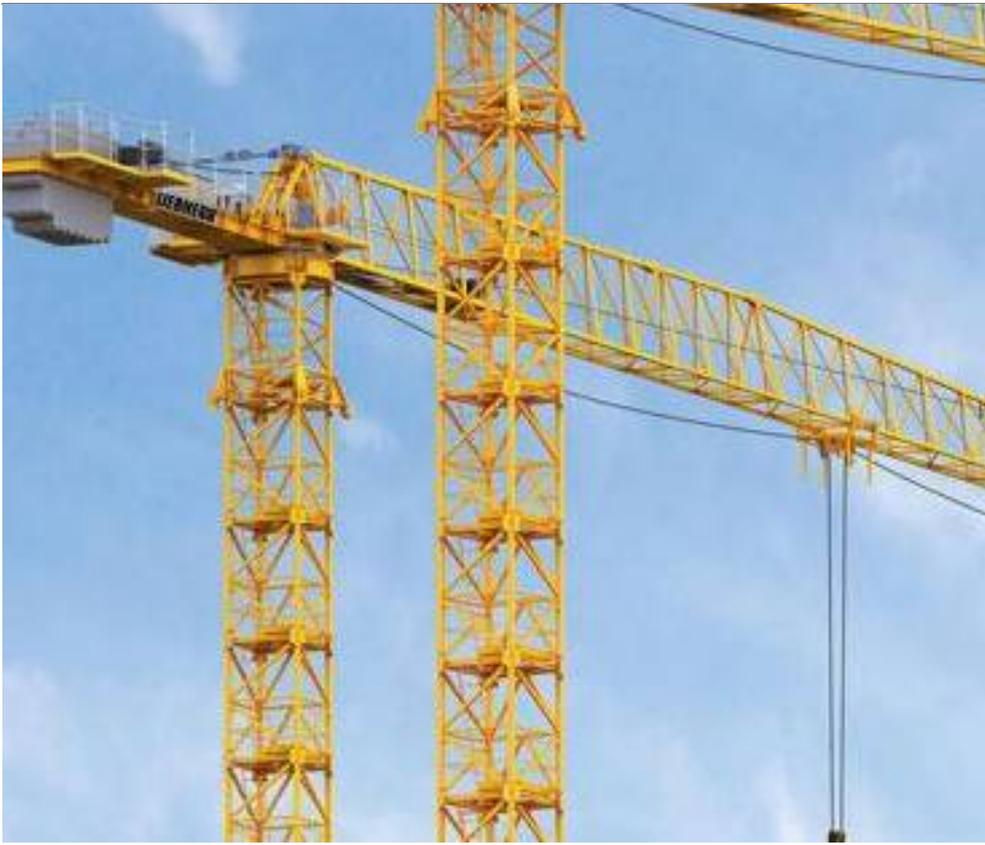
锤头塔式起重机塔吊的主要优势在于起重能力强大、作业范围广泛。它的起重量可以达到数十吨，能够满足各种大型工程的需求。而且，锤头塔式起重机塔吊的高度可调节，可以在不同的高度作业，适应不同建筑物的需求。此外，它的转动角度大，可以灵活转动，覆盖面积广，提高了作业效率。同时，锤头塔式起重机塔吊的操作简便，可以通过控制柜实现远程控制，减少人工操作的不便。
