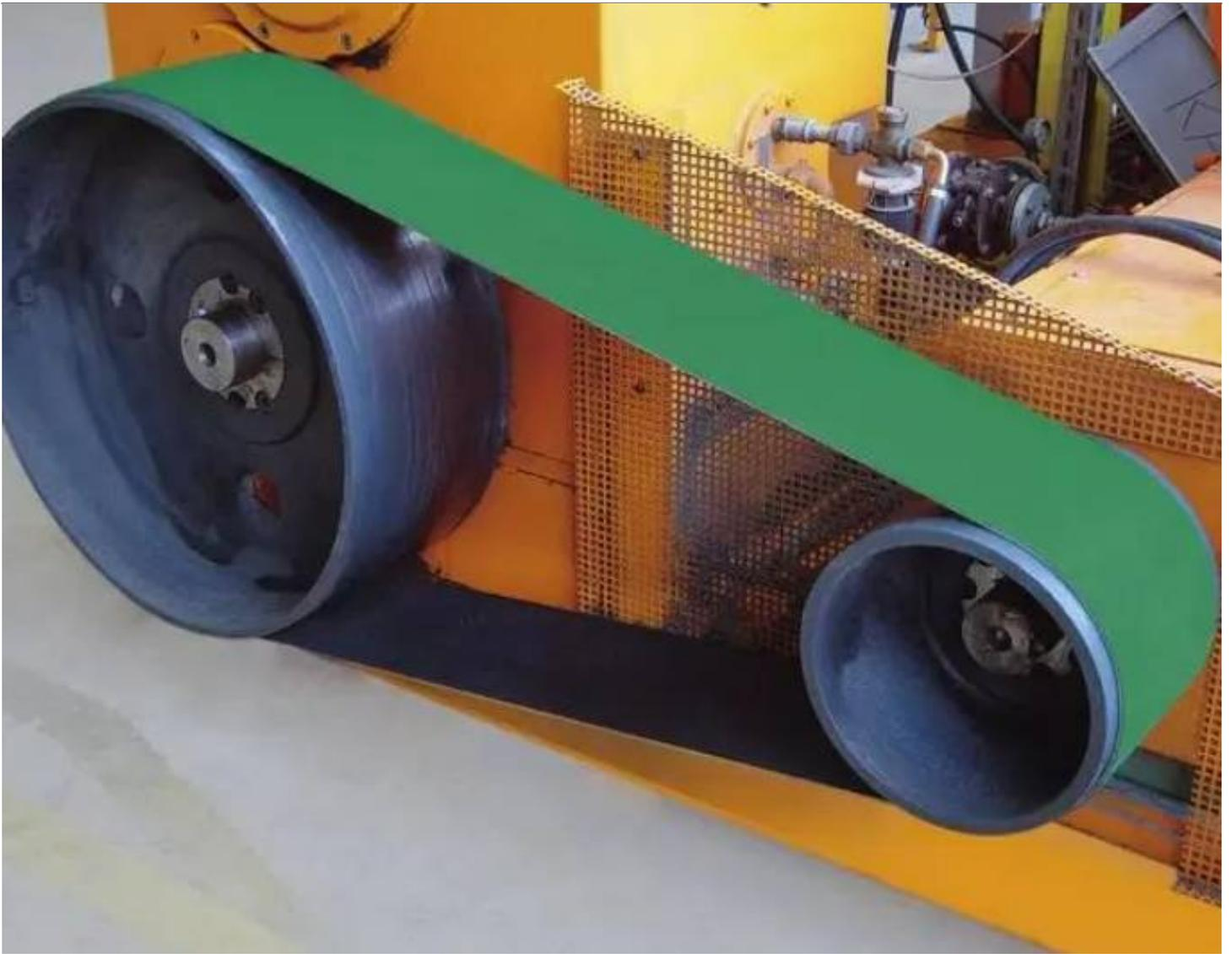
在机床行业中，传动带承担着非常重要的任务。机床作为制造业的核心设备，需要高效而稳定的传动系统来确保工作精度和生产效率。而聚酯运输带传动带正是机床传动系统中的重要组成部分。它可以应用于各种类型的机床，如车床、铣床、磨床等，为机床提供可靠的动力传递和运输支持。
