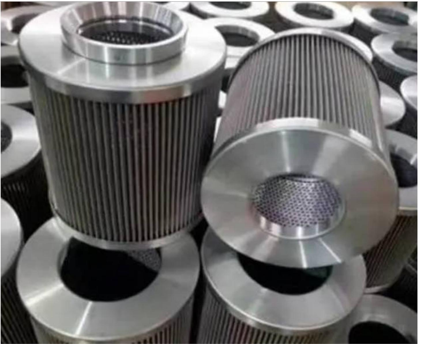
液压回油滤芯作为液压系统中的一个重要环节，主要作用是去除液压油中的杂质和颗粒物，保持液压油的清洁度，防止污染物进入液压系统引起故障。在工作过程中，液压系统难免会产生金属碎屑、铁锈、油泥和油蜡等杂质，这些污染物如果进入液压泵、阀门等部件，将影响系统的正常工作，甚至导致系统故障。而液压回油滤芯的存在，可以有效地阻止这些污染物的进入，保证液压系统的稳定运行。
