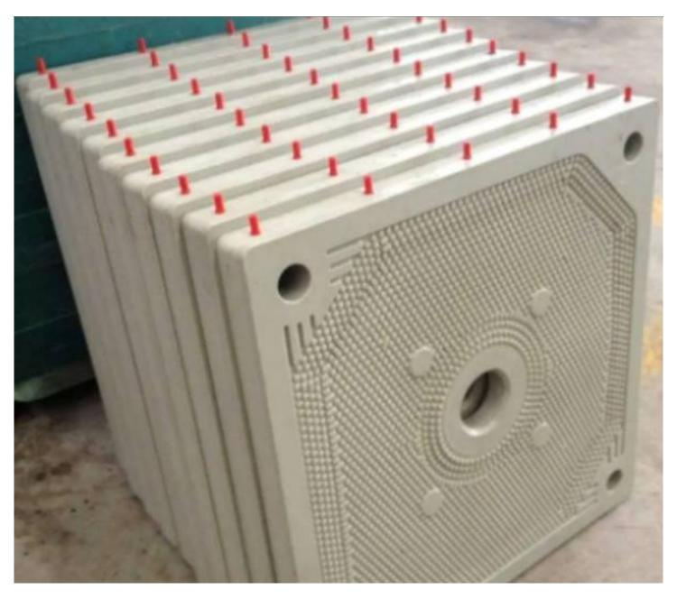
首先,聚丙烯材质的应用使得隔膜压滤机滤板不仅具有了良好的机械强度和耐腐蚀性,还具备了较低的比重和优良的隔热性能。这使得滤板在高温、腐蚀等恶劣环境下都能保持稳定的工作状态,大幅提高了设备的使用寿命。
