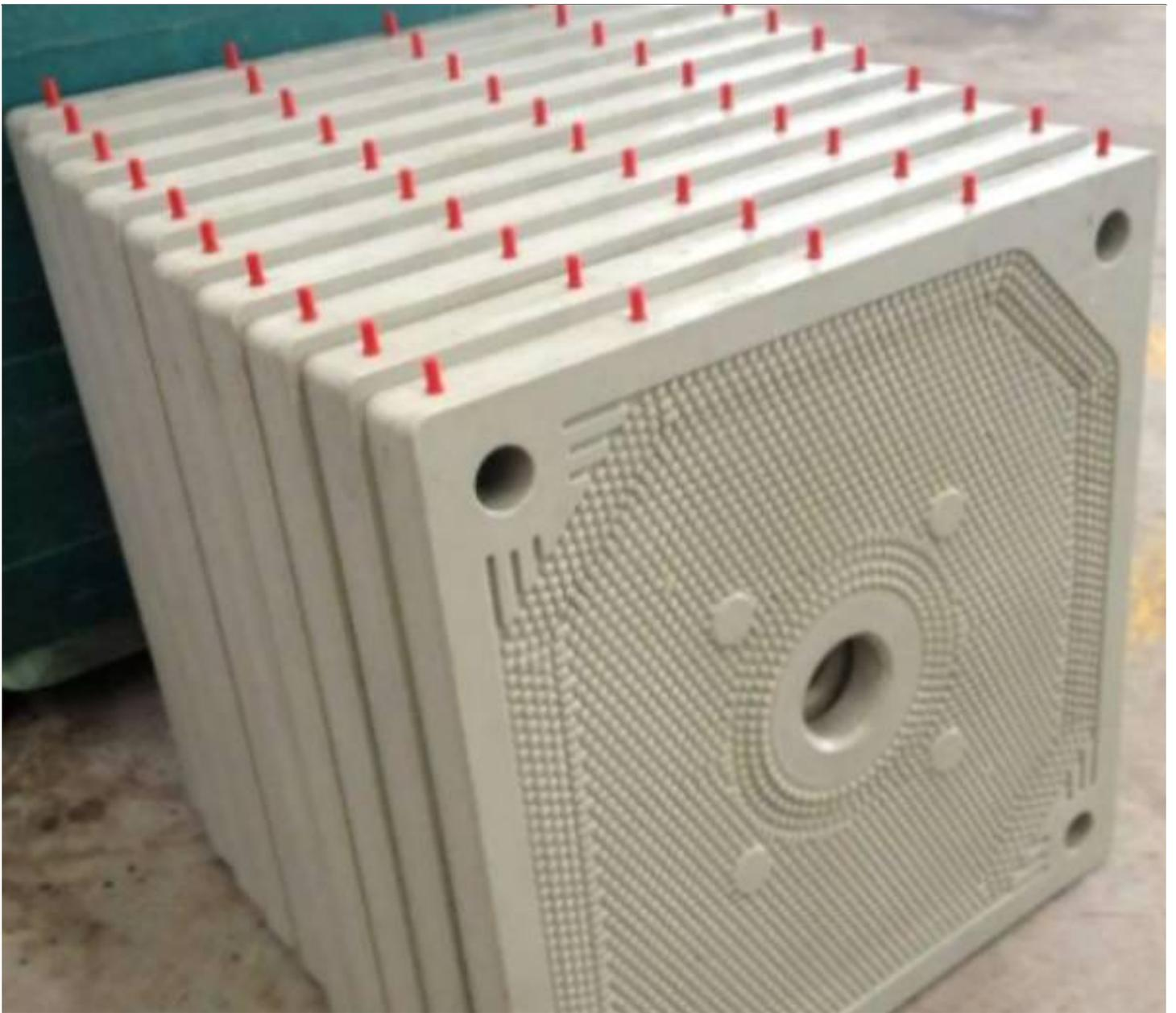
压滤机滤板的材质也是选择时需要考虑的因素之一。不同的泥污物可能对滤板的材质有特殊要求，例如耐腐蚀、耐磨损等。因此，在选择滤板时，我们需要考虑泥污物的特性以及工艺要求，选择合适的材质，以确保滤板的使用寿命和性能稳定。
