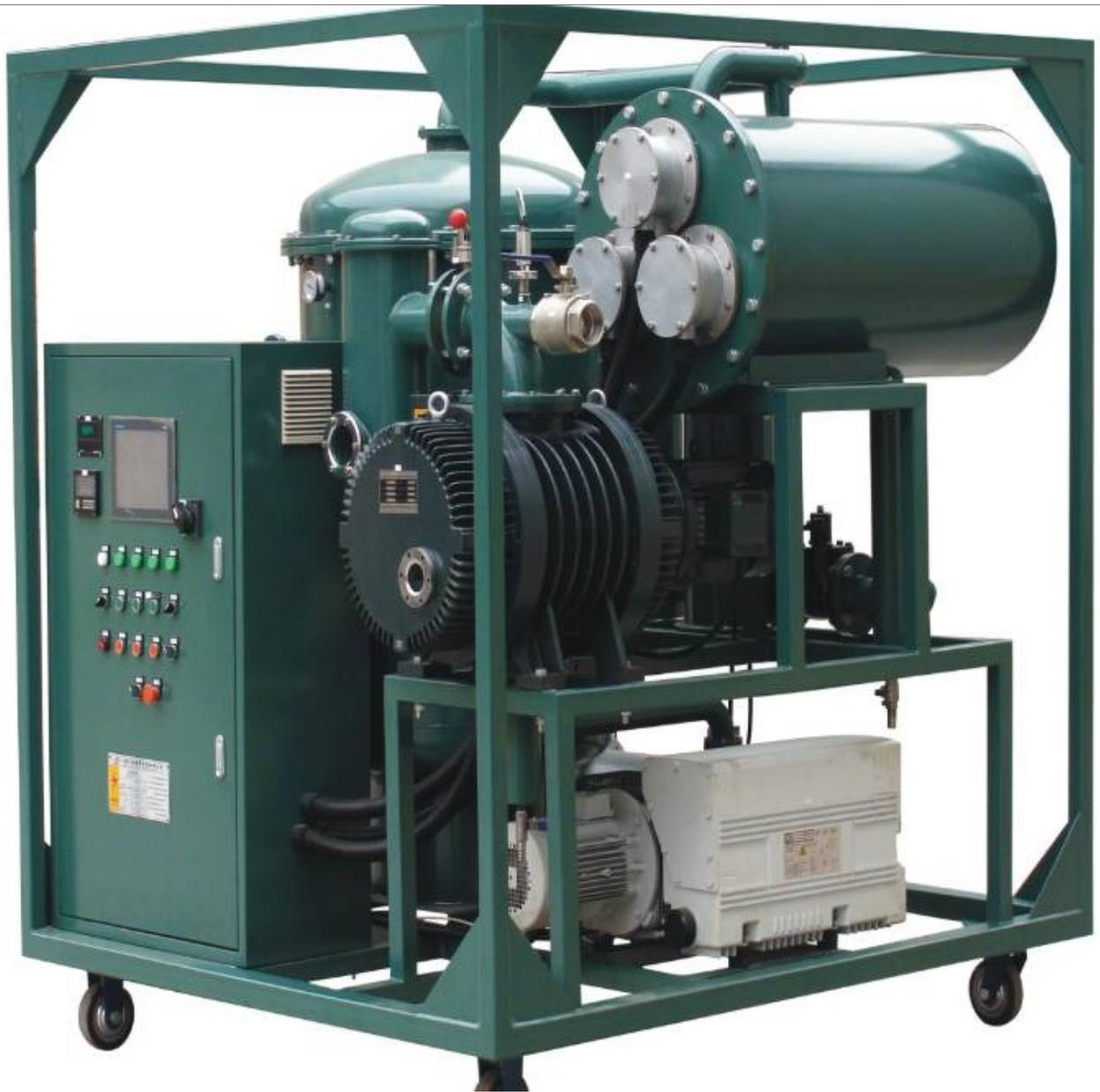
工业液压油滤油机-便移式两级精细滤油机是一款独特的多级过滤机。它具有多项先进的技术和设计，使其在过滤效果、移动性和操作便捷性等方面表现出色。首先，它采用了双级过滤系统，可以同时进行粗滤和精滤，确保液压油中的各种杂质和颗粒被有效过滤。其次，它拥有便移式设计，安装和拆卸非常方便，可以随时随地移动和使用。此外，它还配备有触摸屏控制系统，操作简单，方便快捷。
