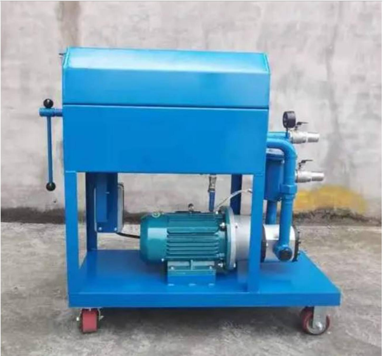
变压器油滤油机主要用于变压器油的过滤和处理。变压器油是变压器正常运行所必需的重要润滑剂和冷却介质。它能够有效地抵御电性击穿，并起到绝缘和冷却作用。然而，随着变压器的运行，变压器油中会逐渐积累水分、杂质和氧化物，导致变压器油质量下降，进而影响到变压器的正常运行。变压器油滤油机的作用就是将这些杂质和水分从变压器油中过滤出来，保证变压器油的纯净度和绝缘性能。常见的变压器油滤油机有手动操作和全自动操作两种，根据使用场景和需求可以选择不同的型号。
