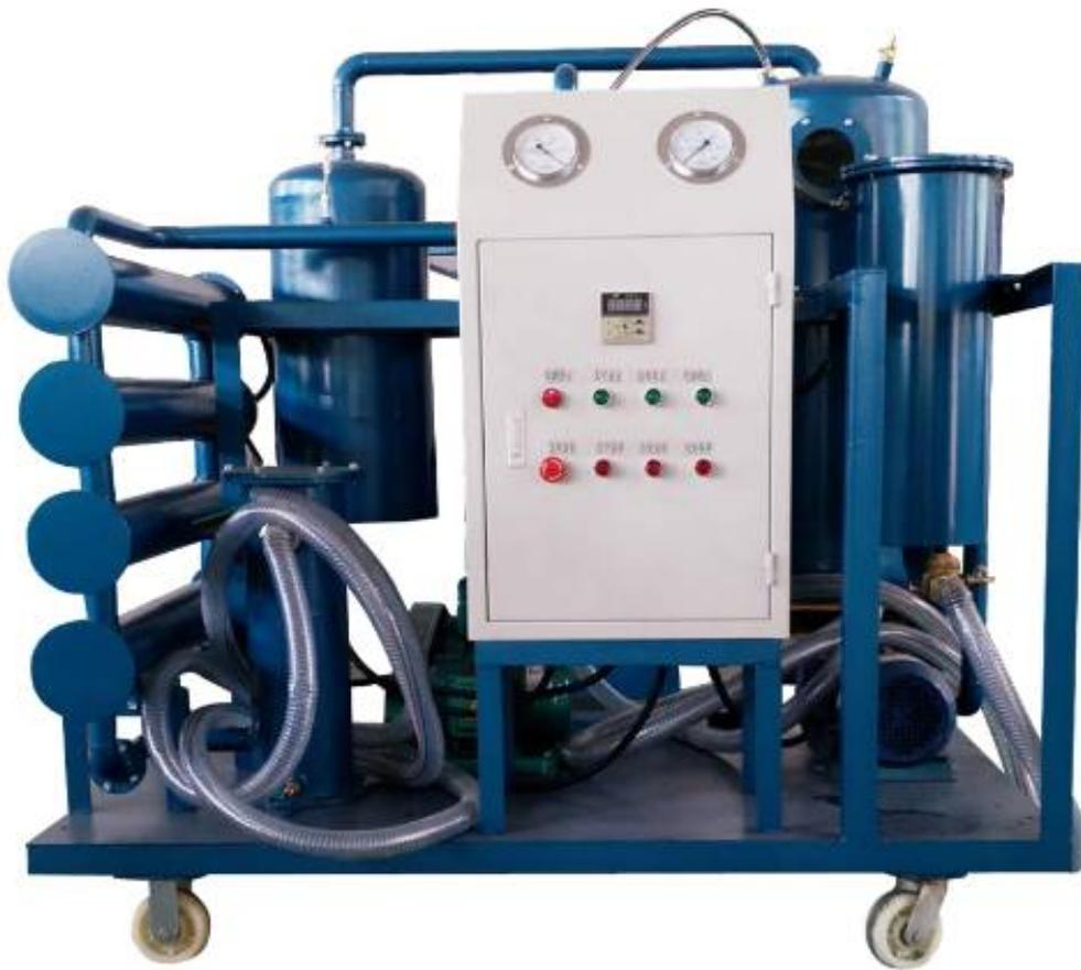
拉丝油过滤机是一种专业的过滤设备，主要用于对拉丝机械中的润滑油进行过滤和净化。拉丝机械在工作过程中，润滑油会逐渐变脏，含有各种颗粒杂质和污染物，如果不及时过滤和清洁，会影响设备的正常运行和产品的质量。拉丝油过滤机通过高效的过滤元件，能够有效地去除润滑油中的杂质和污染物，保证润滑油的纯净度和稳定性，延长机械设备的使用寿命。
