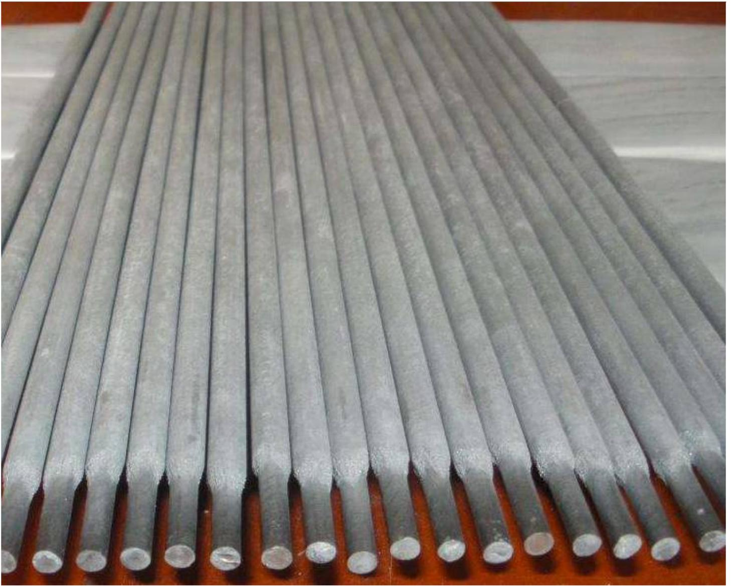
高强钢焊条是一种专用的堆焊焊条，其特点是焊接后的接头具有很高的强度和耐磨性。高强钢焊条适用于各种机械设备、重型工程、矿山设备等需要承受较大压力和磨损的场景。与普通焊条相比，高强钢焊条的焊接接头更加牢固，抗拉强度更高。同时，高强钢焊条还具有良好的耐热性和耐腐蚀性，能够在恶劣的工作环境中长时间稳定运行。
