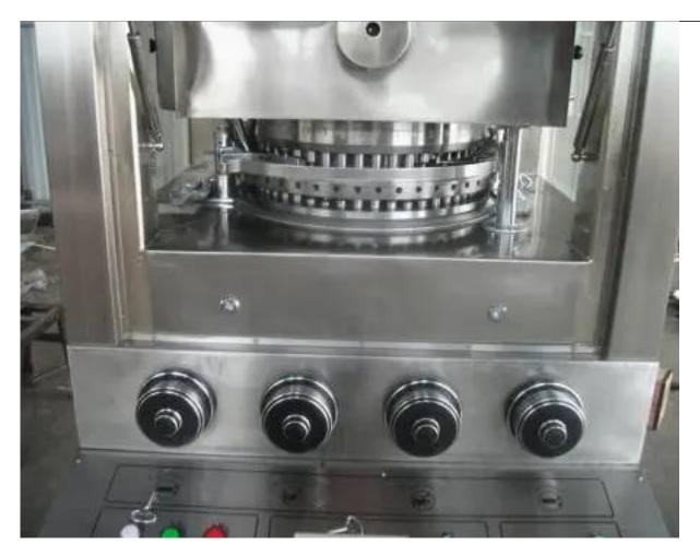
其次,粉末自动压片机具备出色的压片效果。它采用先进的压力传感器和控制系统,能够精确控制压力大小和压片速度,保证了压片过程的均匀性和稳定性。而且,它还具备多种压片模式可供选择,可以根据不同的实验需求来调整,满足不同的压片要求。无论是对于粗粉末还是细粉末,粉末自动压片机都能够实现理想的压片效果,确保产出的样品质量。
