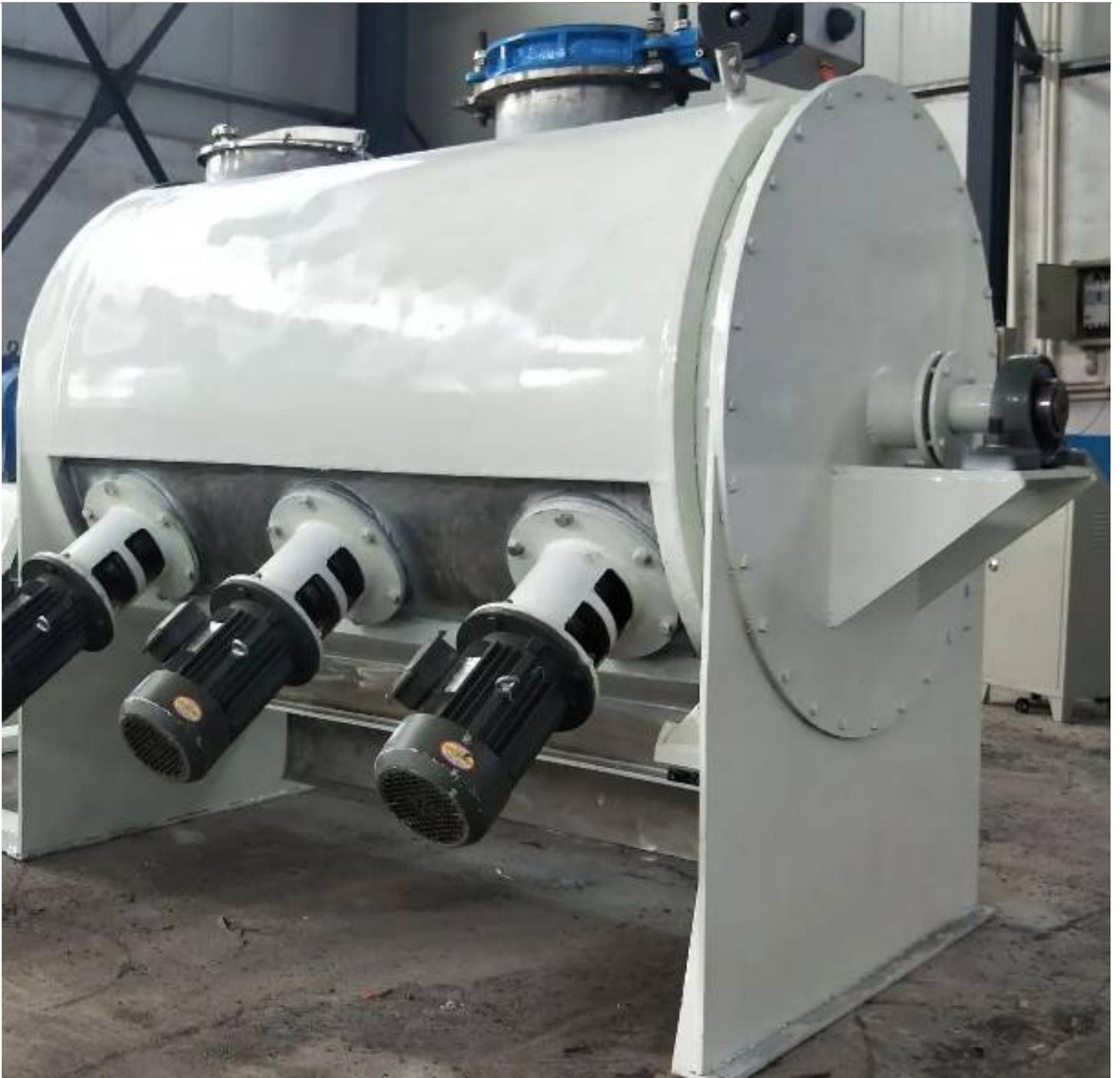
其次，槽型混合机具有高效的混合能力。通过合理的结构设计，槽型混合机能够充分利用物料的重力和机械力，将不同种类的干粉快速混合在一起。其混合均匀度高，能够满足实验室中对于混合质量的严格要求。此外，槽型混合机具有较大的容积，能够一次性混合较大批量的物料，节省了实验室人员的时间和精力。
