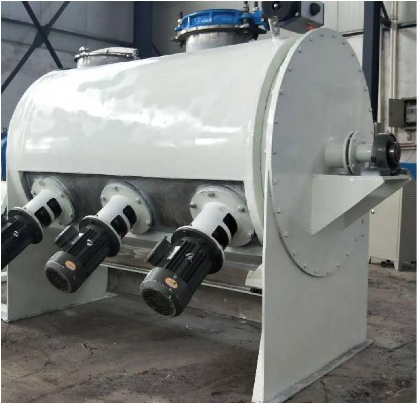
干粉料混合机是一种将干燥的粉末料进行混合的专用设备。它采用特殊的搅拌结构，能够充分混合不同类型和比例的干粉料，确保产品的均匀性。干粉料混合机通常由料斗、搅拌器、传动系统和控制装置等组成。工作时，干粉料通过料斗投入搅拌器中，随着搅拌器的旋转，干粉料在搅拌器内部不断翻滚、抛洒和相互撞击，从而实现混合的效果。干粉料混合机具有结构简单、操作方便、混合效果好等特点，被广泛应用于化工、医药、冶金等行业。
