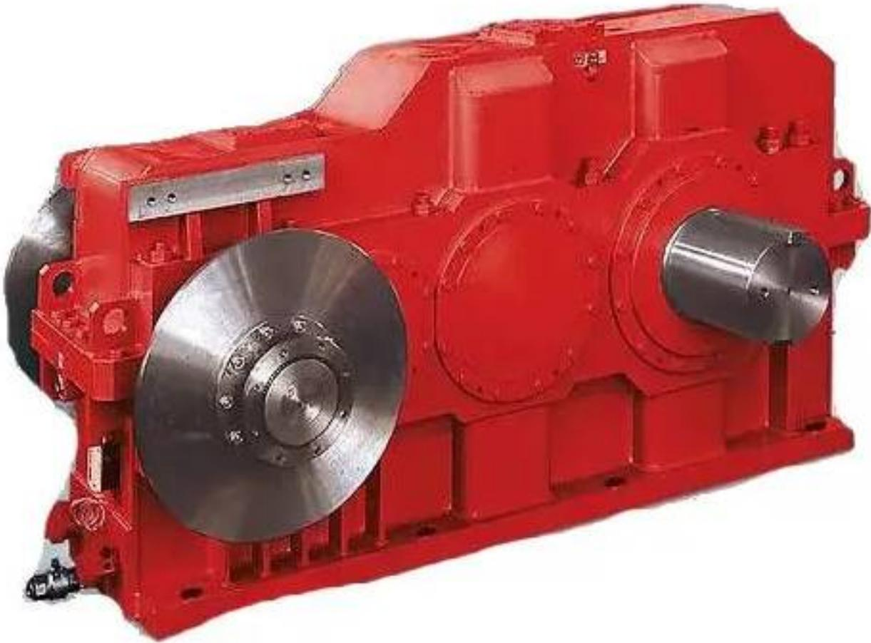
圆柱齿轮减速机是一种以圆柱齿轮为传动元件的减速装置。其特点是结构简单、安装方便、传动平稳、噪音低。这种减速机适用于对传动要求较高的机械设备，如起重机械、轧钢机、水泥搅拌机等。圆柱齿轮减速机的优点在于传动效率高，承载能力强，运行稳定可靠。其缺点是体积较大，重量较重，需要专门的空间进行安装和维护。然而，基于其可靠性和稳定性，圆柱齿轮减速机仍然是工业制造领域中广泛应用的传动装置之一。
