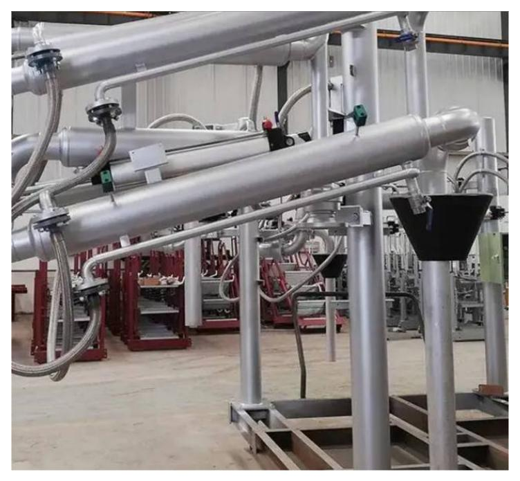
装卸臂万向节充装鹤管是底部装车鹤管的一个重要组成部分。它可以根据需要进行调节和旋转,实现货物在垂直和水平方向上的精确定位。装卸臂万向节充装鹤管具有灵活多变的特点,可以适应不同尺寸和重量的货物装卸需求。同时,它的设计使得装卸过程更加安全高效,可以提高工作效率,降低劳动强度。
