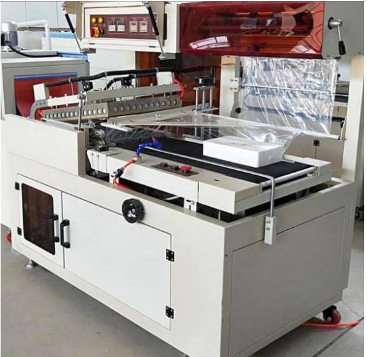
全自动热收缩膜包装机的主要特点是高度自动化。它采用先进的PLC控制系统，具备自动送料、自动封切、自动温度控制等功能，大大提高了包装的效率和质量。无论是小型产品还是大型产品，都能轻松应对，实现批量生产。与传统的人工包装相比，全自动热收缩膜包装机不仅节约了人力成本，还提高了包装的一致性和美观度。
