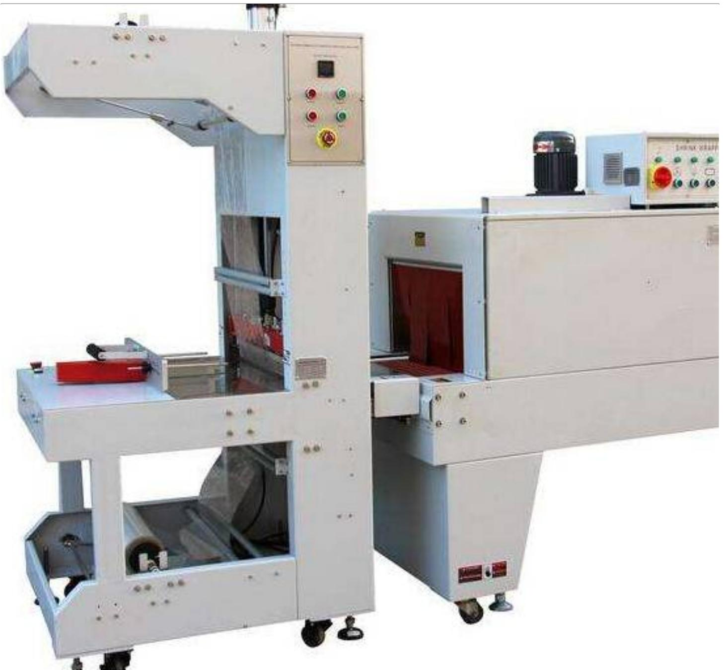
该机器采用全自动化操作，通过PLC控制系统实现自动送料、定位、封切、收缩等功能，无需人为干预，大大提高了生产效率和包装质量。配备先进的传感器和伺服驱动系统，能够准确感知产品的位置和尺寸，并精确调节包装参数，确保每个产品的包装效果一致。另外，该机器还具备自动故障检测和报警功能，及时排除故障，保障生产线的连续运行。
