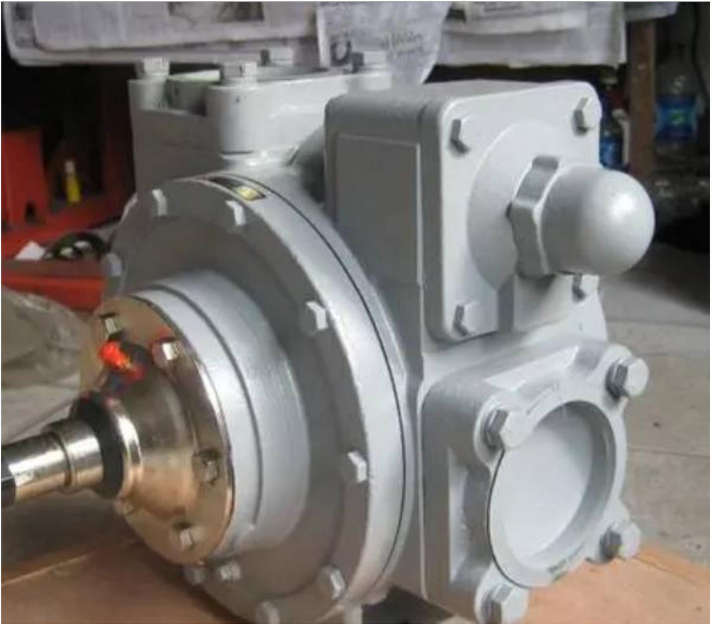
自吸泵是一种方便实用的泵，具有自吸能力，能够在不停机的情况下自行排空管路中的空气，实现自动吸入液体。它适用于输送各种清洁液体，广泛应用于农业灌溉、城市供水、工业水处理等领域。
