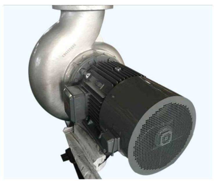
除了叶轮的设计,半开式叶轮卧式单极泵的结构也是其独特之处。它采用卧式结构,泵体与电机通过联轴器连接,安装方便,占地面积小。此外,半开式叶轮泵的进出口可根据使用需求灵活调整,使得装置更加灵活多变。同时,泵外壳采用不锈钢材质制成,使得半开式叶轮卧式单极泵能够适应更广泛的工况,具有更好的耐腐蚀性能。
