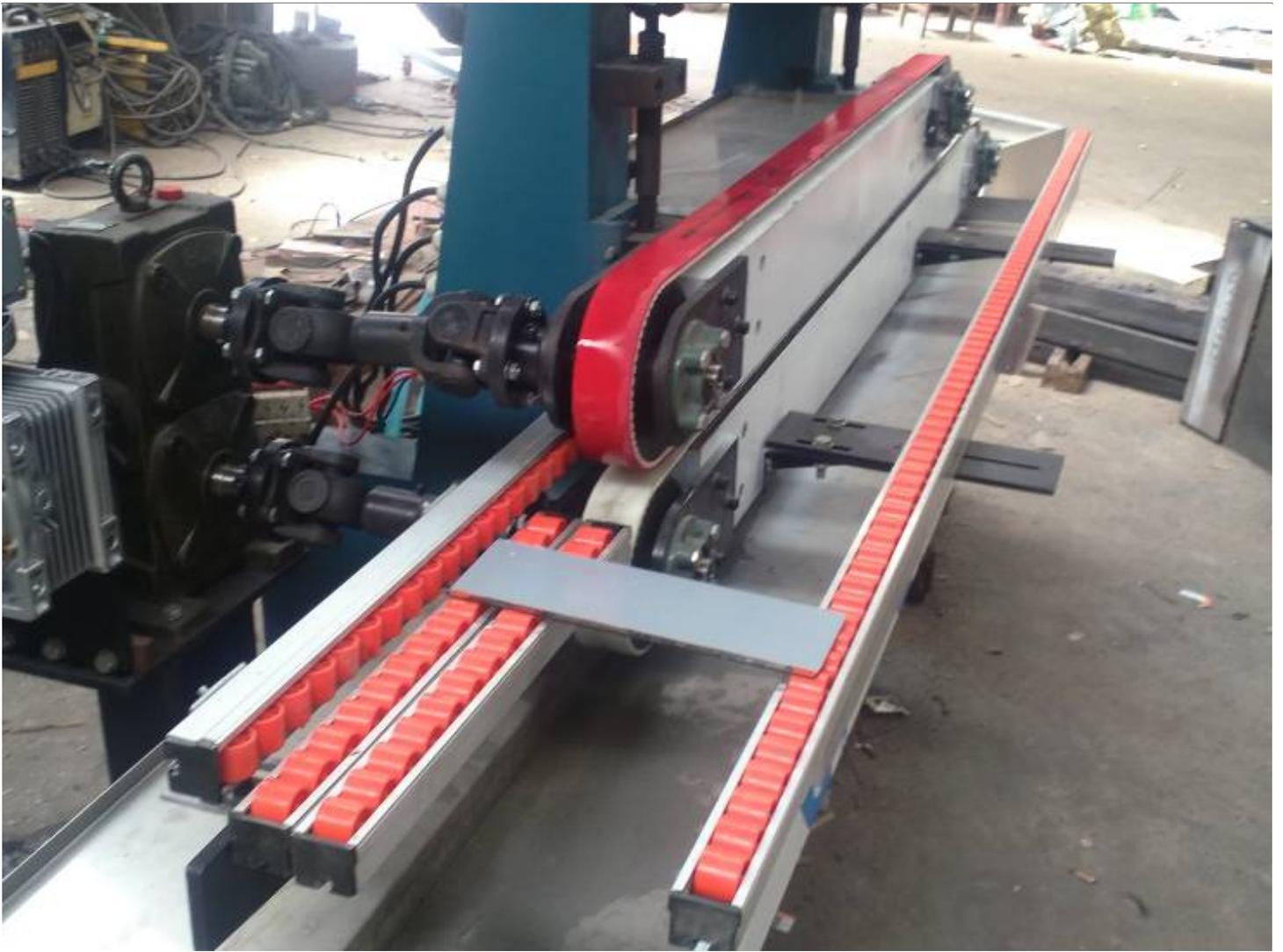
卧式玻璃清洗机是另一种重要的玻璃加工设备，它主要用于清洗玻璃表面的杂质和污垢。在玻璃加工过程中，玻璃表面往往会附着有各种灰尘、油渍和污垢，如果不进行清洗处理，将会对加工质量和制品的外观产生不良影响。卧式玻璃清洗机采用喷淋、刷洗和烘干等多种功能模块，通过循环水系统和高效的喷淋装置，可快速、有效地将玻璃表面的污垢去除，同时在清洗过程中保持玻璃平整和不变形，确保加工质量的稳定性和可靠性。
