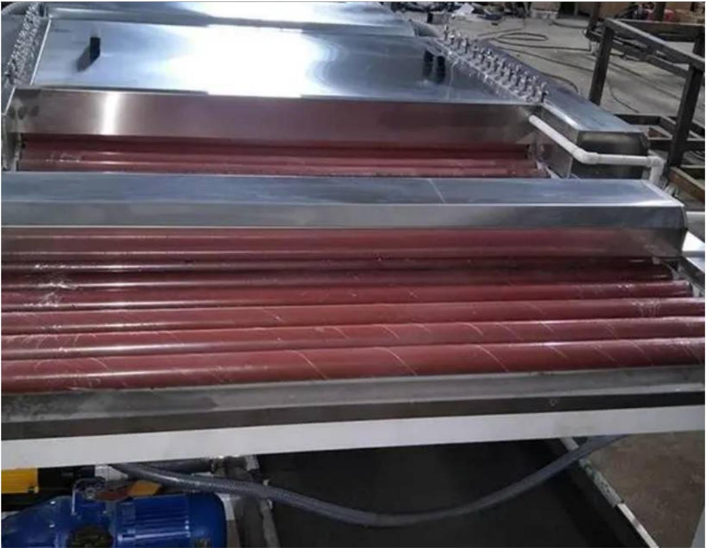
接下来，让我们来了解一下玻璃清洗机。玻璃清洗机是专门用于清洗玻璃表面的设备。它采用喷淋和刷洗的方式，能够彻底去除玻璃表面的污垢、油渍和其他杂质，使得玻璃表面干净透明。玻璃清洗机具有自动化程度高、清洗效果好、操作简便的特点。它广泛应用于建筑、家居、电器等行业，为这些行业提供了干净优质的玻璃材料。
