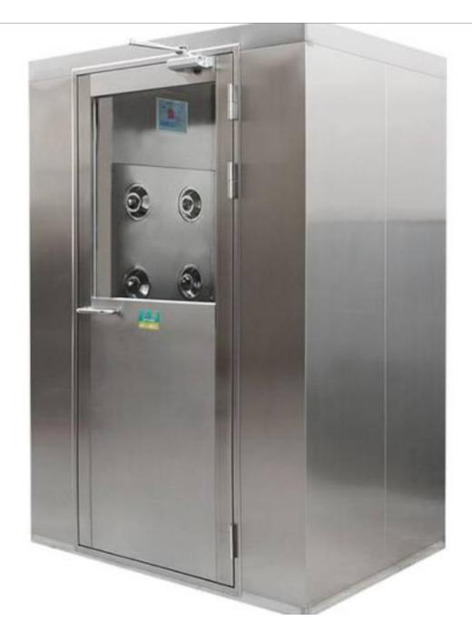
风淋室是无尘车间中重要的一环,它起到了去除微尘及杂质的效果。风淋室内通过高速气流形成的"风墙"将入口区域的微尘隔离,确保进入无尘车间的人员和物品的洁净状态。风淋室的风速通常达到2-3m/s以上,风速越高,风淋效果越好,对工作人员和物品的清洁度要求也越高。不同的无尘车间和行业对风淋室的要求也不尽相同,双人风淋室和单人智能风淋门成为了市场上热销的产品。
