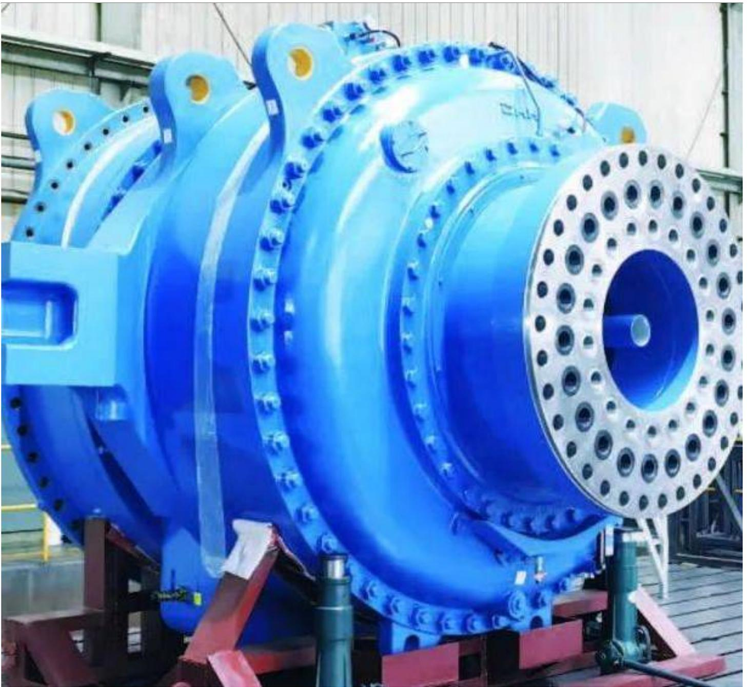
精密行星齿轮箱是齿轮传动技术中的一种高精度设备，被广泛应用于精密仪器、数控机床等领域。精密行星齿轮箱通过行星轮和太阳轮的组合传动，实现了高效稳定的动力输出。其特点是传动平稳、噪音低、寿命长，并且具备高速传动能力和高扭矩输出能力，适用于各种对传动精度和可靠性要求较高的场合。
