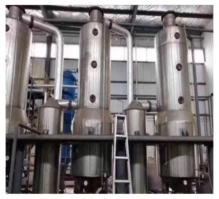
而减压降膜蒸发器则是采用降低压力的方式来促进液体蒸发的,其立式结构使得气液分离更加彻底,从而提高了传热效率。此外,立式结构还可以使得设备的占地面积更小,更加节省空间。而且,减压降膜蒸发器在运行过程中,不仅可以实现蒸发传热,还可以同时实现以及液体预热,从而提高了能源利用率。
