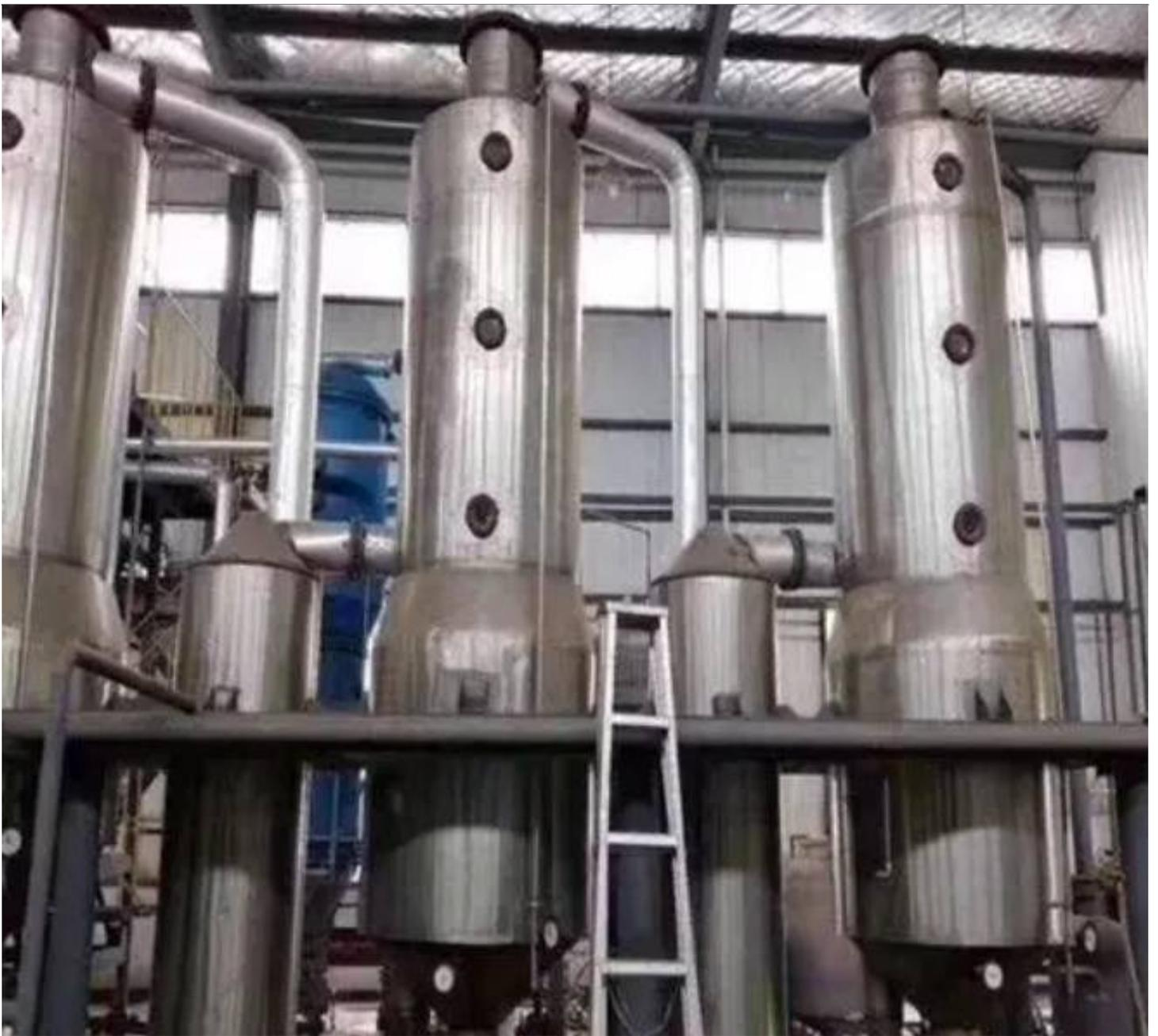
结晶浓缩蒸发器是一种将液体中的溶质通过蒸发浓缩至饱和度后，使其溶质结晶的设备。它采用多效蒸发原理，通过连续蒸发多个效应器，可以达到较高的浓缩效果。结晶浓缩蒸发器适用于溶液浓缩、盐类结晶、晶体分离等工艺。它具有结构紧凑、能耗低、操作简便等特点，被广泛应用于食品加工、制药生产、化工等领域。
