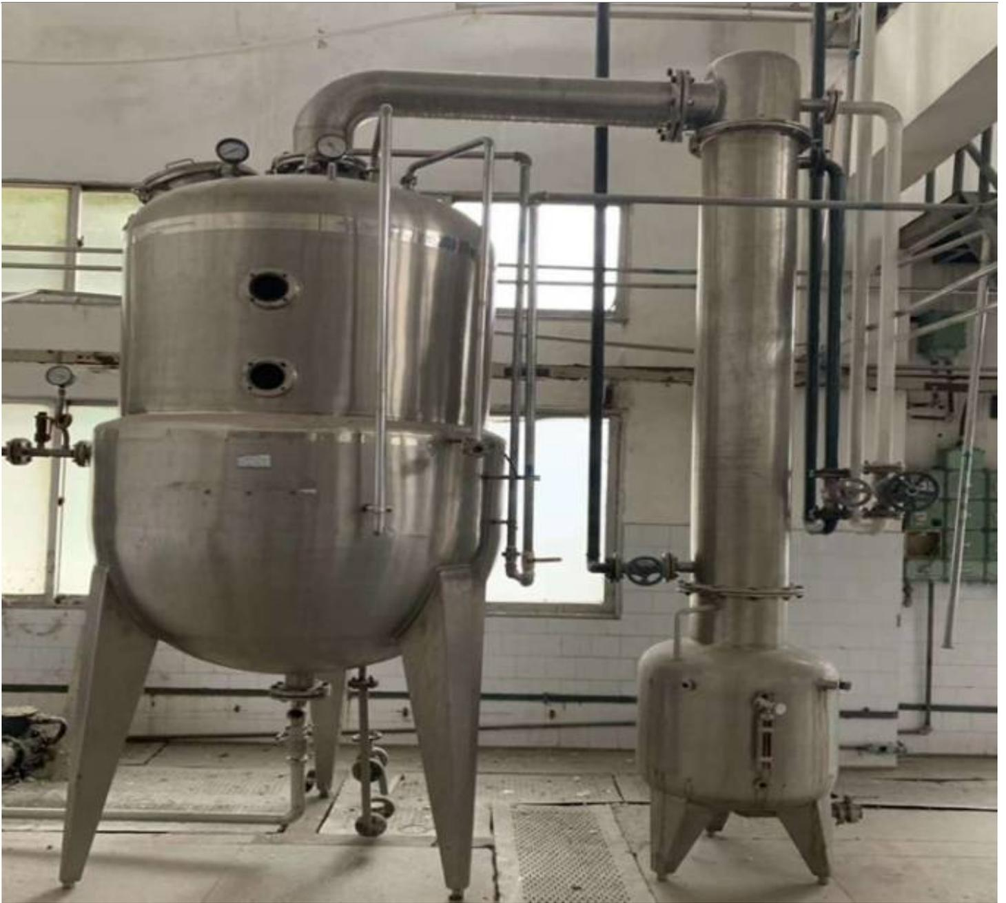
然而，传统的刮板薄膜蒸发器还存在一些问题，比如热能的浪费和操作的复杂性。为了解决这些问题，研究者们开始探索结晶浓缩蒸发器的发展。结晶浓缩蒸发器通过将待处理物料在真空条件下蒸发，使得溶质在过饱和度条件下结晶，从而实现溶液的浓缩。结晶浓缩蒸发器具有能耗低、结晶效果好等优点，成为了一种值得推广的新型蒸发设备。
