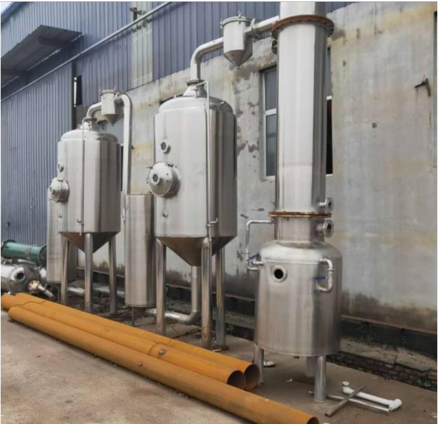
干式壳管式蒸发器是一种常见的传统蒸发器，它的工作原理是将溶液置于壳管之间，通过外部加热使得溶液蒸发，从而实现溶质的浓缩。相比于加压三效蒸发器，干式壳管式蒸发器的工作压力较低，因此蒸发速度较慢。但是干式壳管式蒸发器结构简单、操作方便，能够适应不同工艺要求，因此在一些行业中仍然得到广泛应用。
