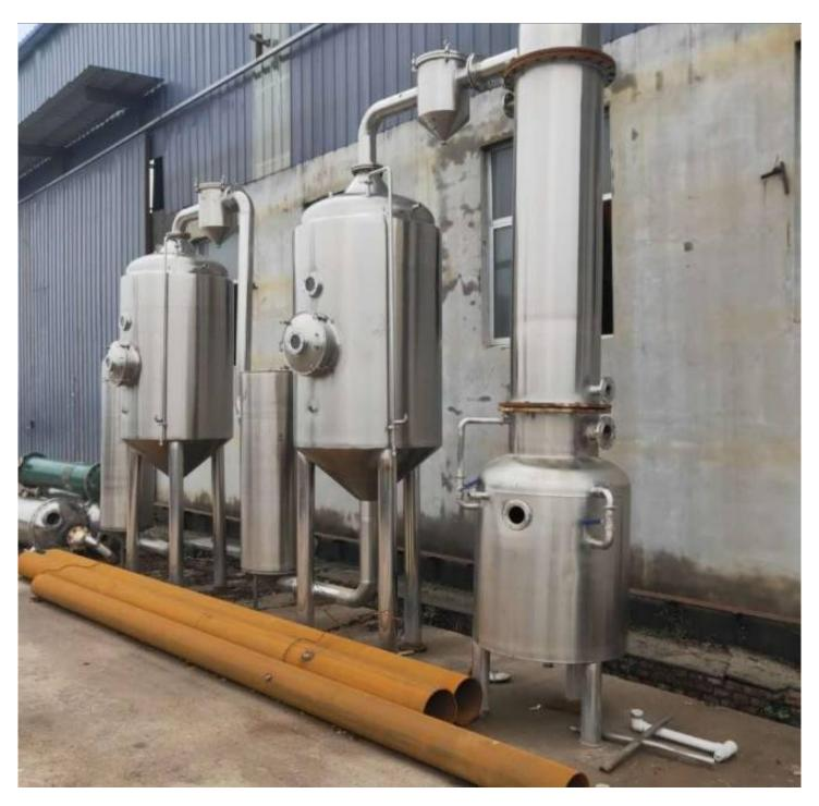
其次,减压降膜蒸发器是一种通过低压作用实现蒸发的设备。它采用了降膜传热的原理,将废水喷 洒在多层降膜板上,在低压下蒸发,将废水中的溶质分离出来。减压降膜蒸发器在工业废水处理中具 有结构简单、操作方便、蒸发效率高的特点。而且,由于采用了降膜传热方式,减压降膜蒸发器对废 水的起泡和结垢现象较少,能够保证设备的长期稳定运行。
