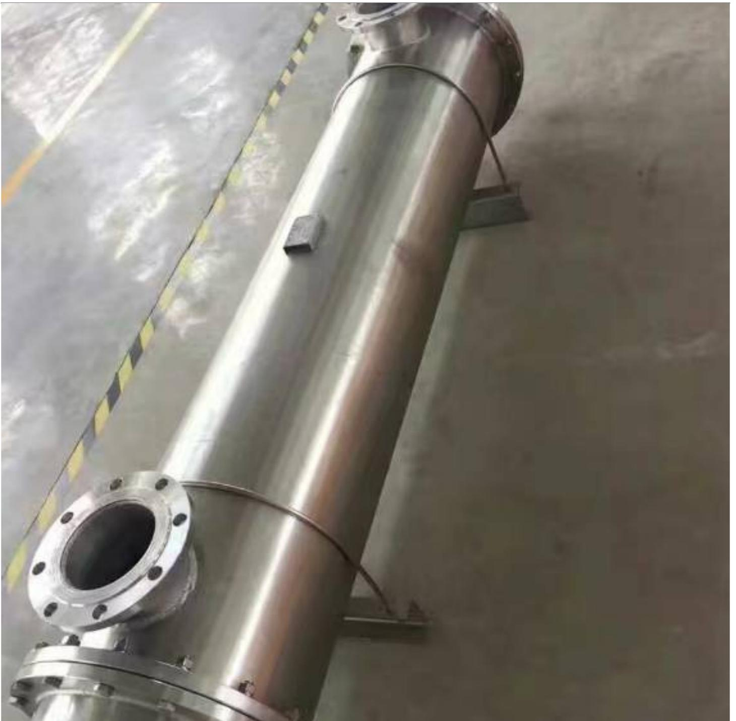
与之相比，U型列管式换热器也是一种常见的换热器技术。其结构类似于字母“U”，在换热管内部通过流体进行传热。这种换热器的特点在于使用流体更加均匀，能够达到更高的换热效果。在中央空调系统中，U型列管式换热器广泛用于热水供应、暖通空调以及工业制冷等领域。
