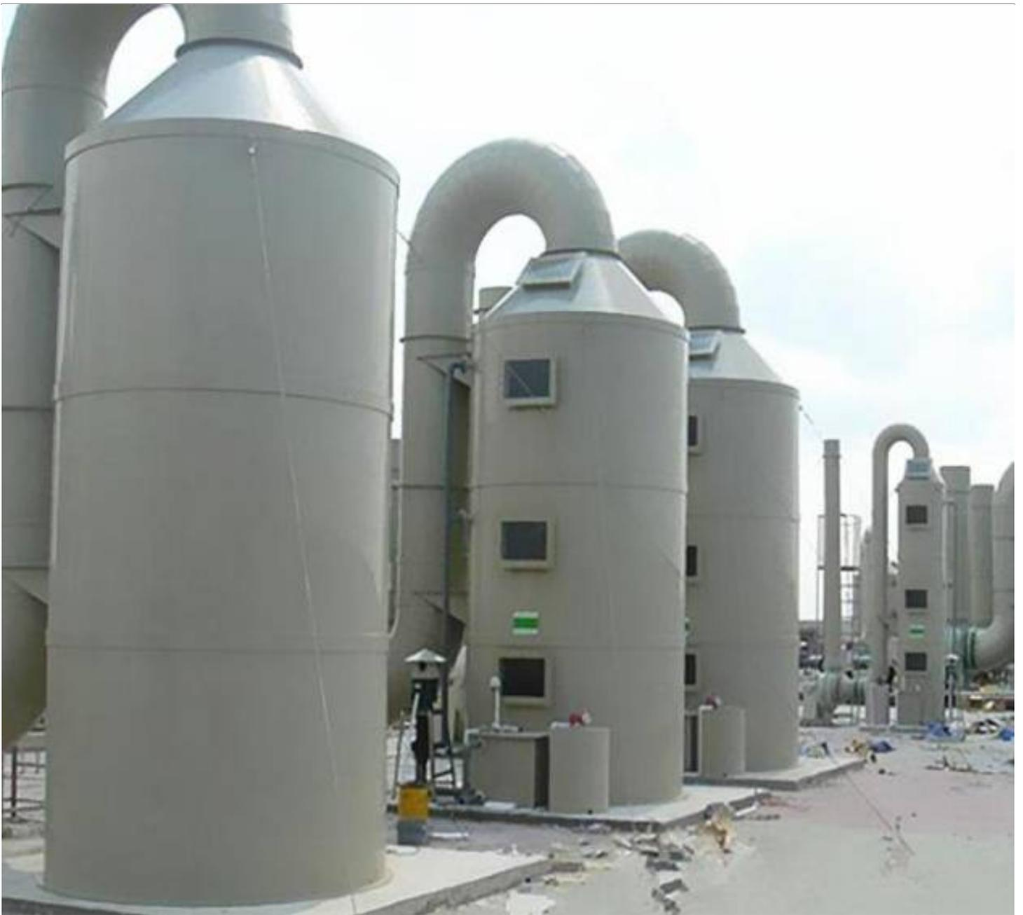
其次，聚丙烯PP填料塔还具有出色的耐高温性能。在化工生产中，很多工艺过程需要在高温条件下进行，如果选择的塔体材料不能够承受高温的热力冲击，很容易导致设备的损坏和事故的发生。而聚丙烯PP填料塔具有良好的耐热性能，能够稳定地运行在高温环境下，确保设备的安全和可靠性。
