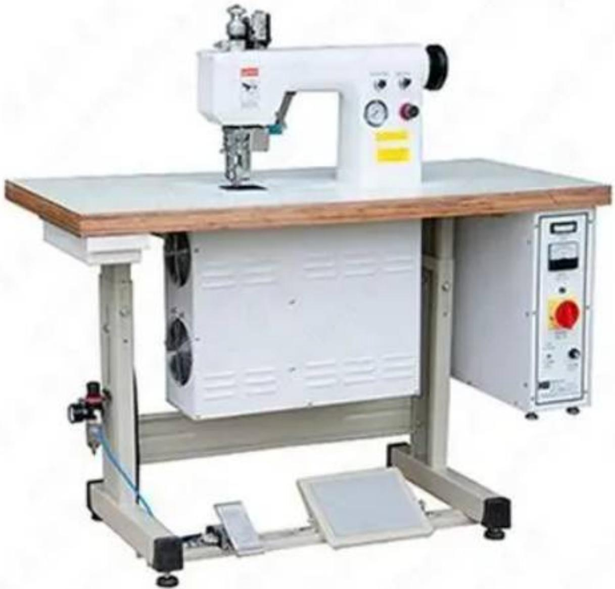
枕头套花边机作为超声波布料镂空花边机的延伸应用，专门用于枕头套的装饰。枕头套是人们日常生活中常用的家居用品，通过使用枕头套花边机，可以给普通的枕头套添加独特的花边图案，让它更具装饰性和艺术感。这种机器采用PLC控制技术，具有高度自动化的特点，可以自动调整参数、控制工作速度和操作模式，极大地提高了工作效率和制作精度。枕头套花边机适用于各种材质的枕头套，如棉质、丝质、麻质等，通过调整机器的参数和花边图案设计，可以实现不同风格和风格的装饰效果。因此，枕头套花边机也是个性化家居装饰的理想选择。
