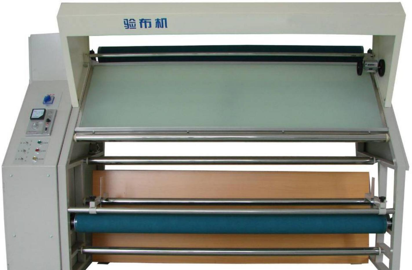
多功能卷布验布机不仅具备数字化电脑半自动验布机的功能，还具有更多的功能和特点。它采用先进的传感器技术，可以实现对布料的全方位检测和分析。它可以自动识别不同的布料规格和材质，智能调整验布参数，提高验布的准确性和稳定性。同时，它还具备自动辊布、自动卷布、自动剪布等功能，大大提高了工作效率和生产效益。
