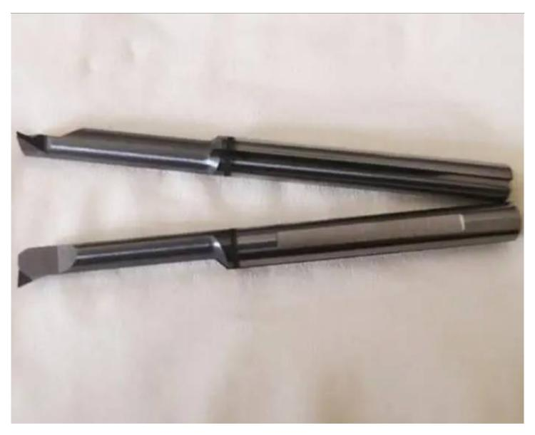
大径粗镗刀是一种用于加工大孔径的工具。它的特点是具有很好的刚性和稳定性,可以在高转速下进行高效的削减。大径粗镗刀广泛应用于航空、航天、汽车、船舶等制造行业,能够加工各种材料,包括铸铁、钢材、铝合金等。同时,大径粗镗刀还可以用来削减各类内螺纹和外螺纹,具有多种用途
