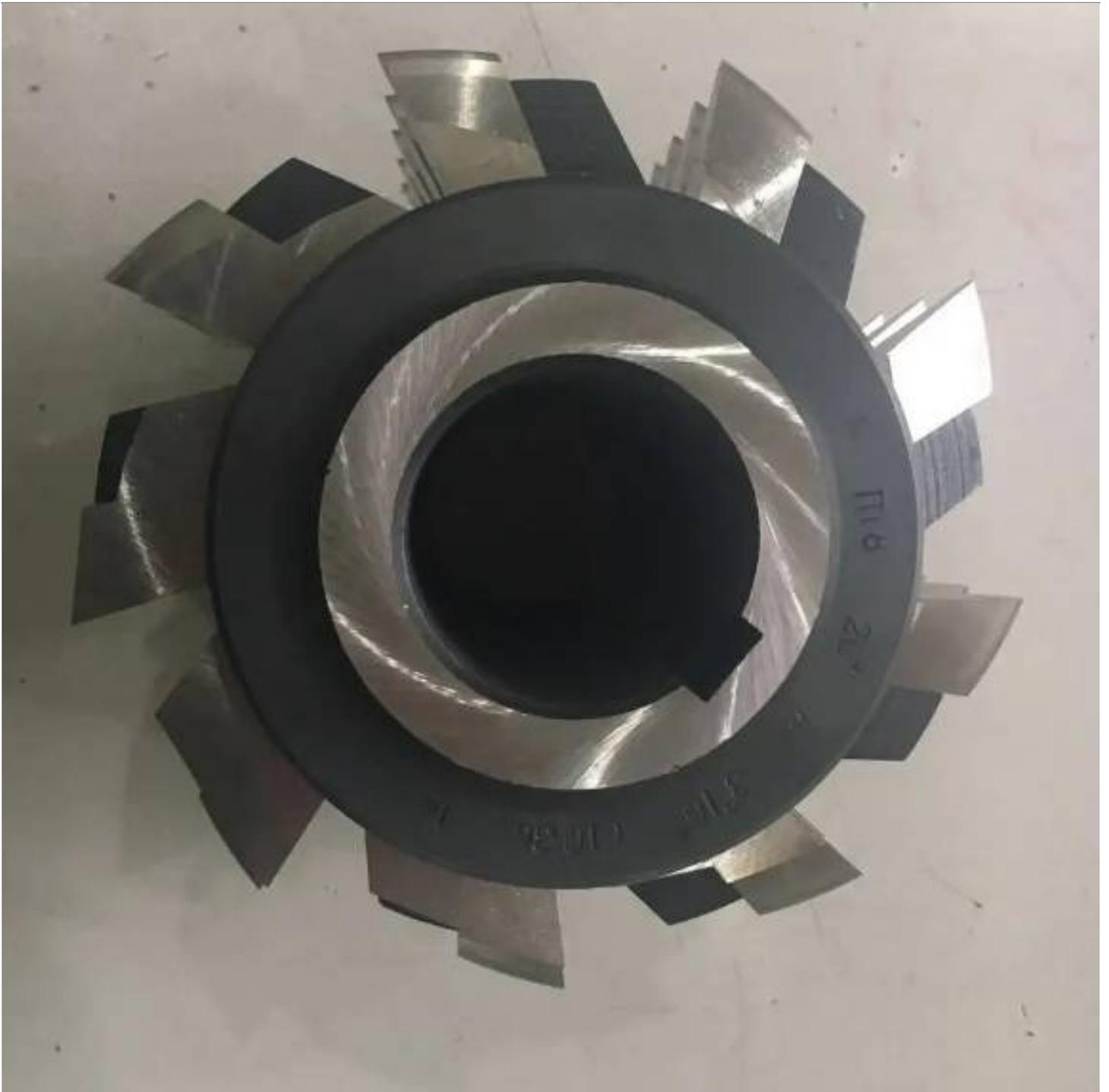
硬质合金材料被广泛应用于蜗轮滚刀的制造中。硬质合金的硬度高、耐磨性好，能够有效抵抗加工过程中的磨损和变形。同时，硬质合金的耐热性和耐腐蚀性也使得蜗轮滚刀在高温和腐蚀环境下具有出色的表现。
