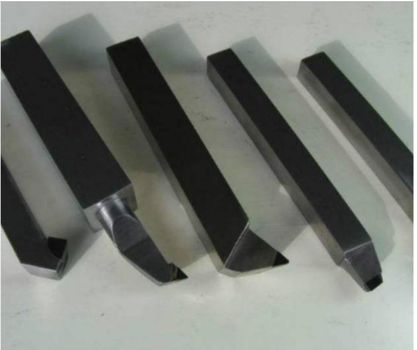
然而，由于高速钢车刀的刀头容易受到较大的切削力和冲击力，从而导致刀头磨损较快，影响刀具使用寿命。为了克服这一问题，硬质合金刀头应运而生。
