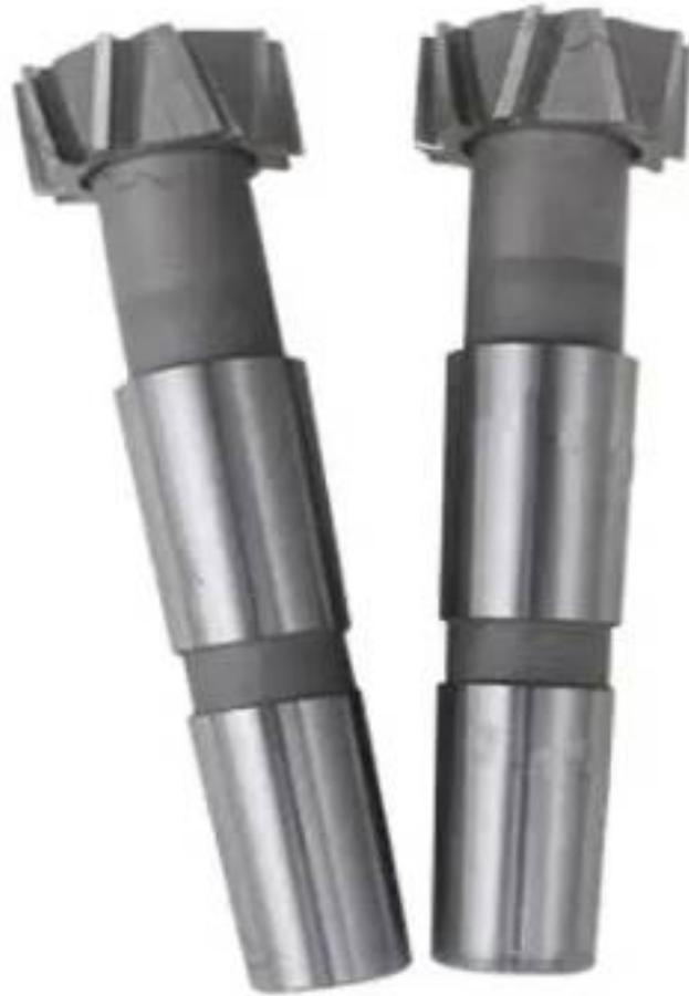
硬质合金直柄T型槽铣刀常用于金属加工中，特别适用于开槽、铣槽和挖槽等作业。其刀片切削面由多个刀齿组成，使得刀具能够同时进行多道切削，提高了加工效率。同时，硬质合金材料使刀片具有较高的耐磨性和热稳定性，延长了刀具的使用寿命。
