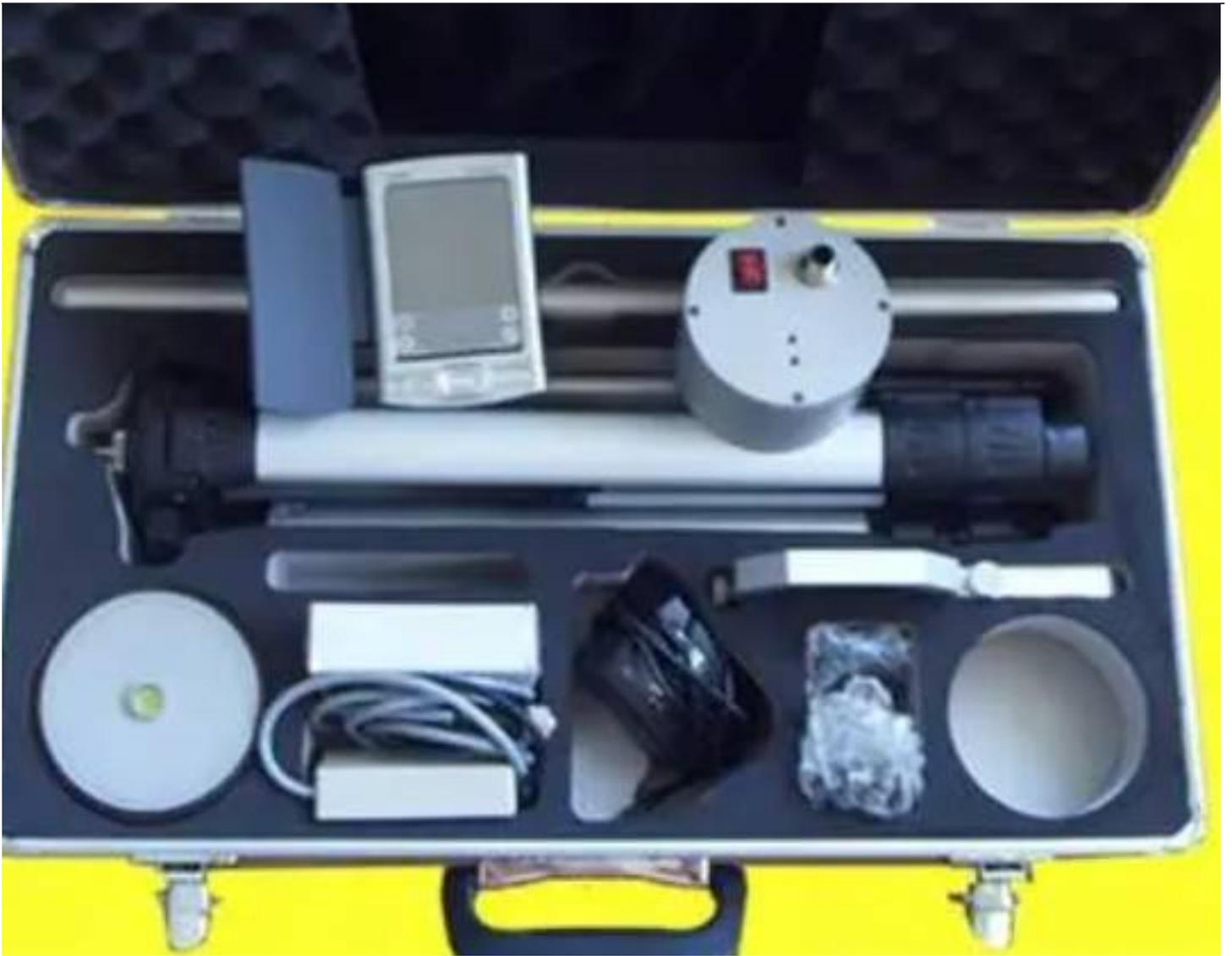
矿山用氡气测量仪则是一种专门用于测量地下氡气浓度的仪器。氡气是一种无色、无味的情性气体，是地下矿脉中常见的放射性元素。通过利用氡气的放射性特性，可以非侵入性地测定矿脉的存在及其规模。矿山用氡气测量仪可以通过测量地下氡气浓度来判断矿脉的位置、赋存形式和开采潜力，对矿山的勘探和开发具有重要的指导意义。
