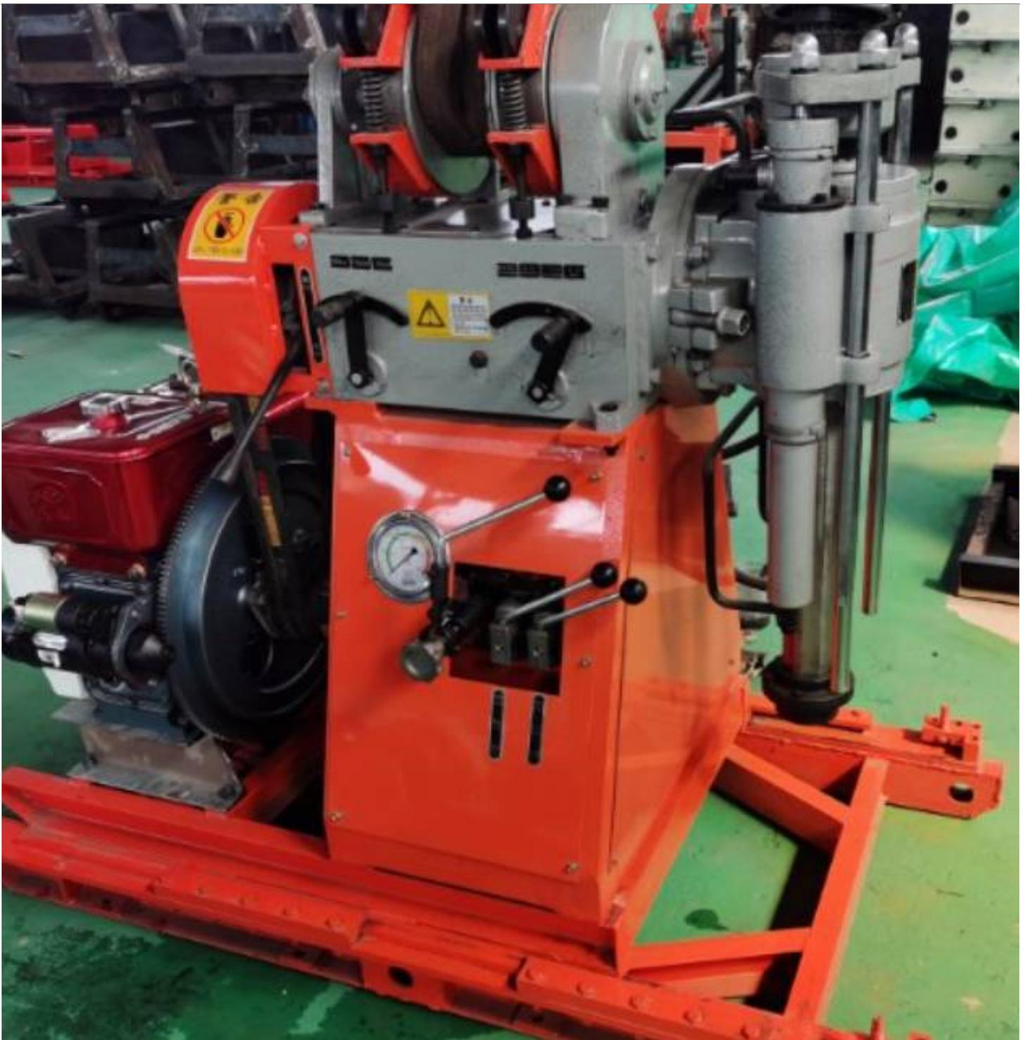
这款钻机还具备多项先进技术。首先，它采用自动化控制系统，实现了钻探过程的智能化操作，大幅降低了操作难度，提高了作业精度。其次，钻机配备了先进的取芯装置，能够准确地提取岩芯，为后续的地质勘察和研究提供可靠的样本。另外，全液压钻机还具备远程控制功能，操作上更加便捷和安全。
