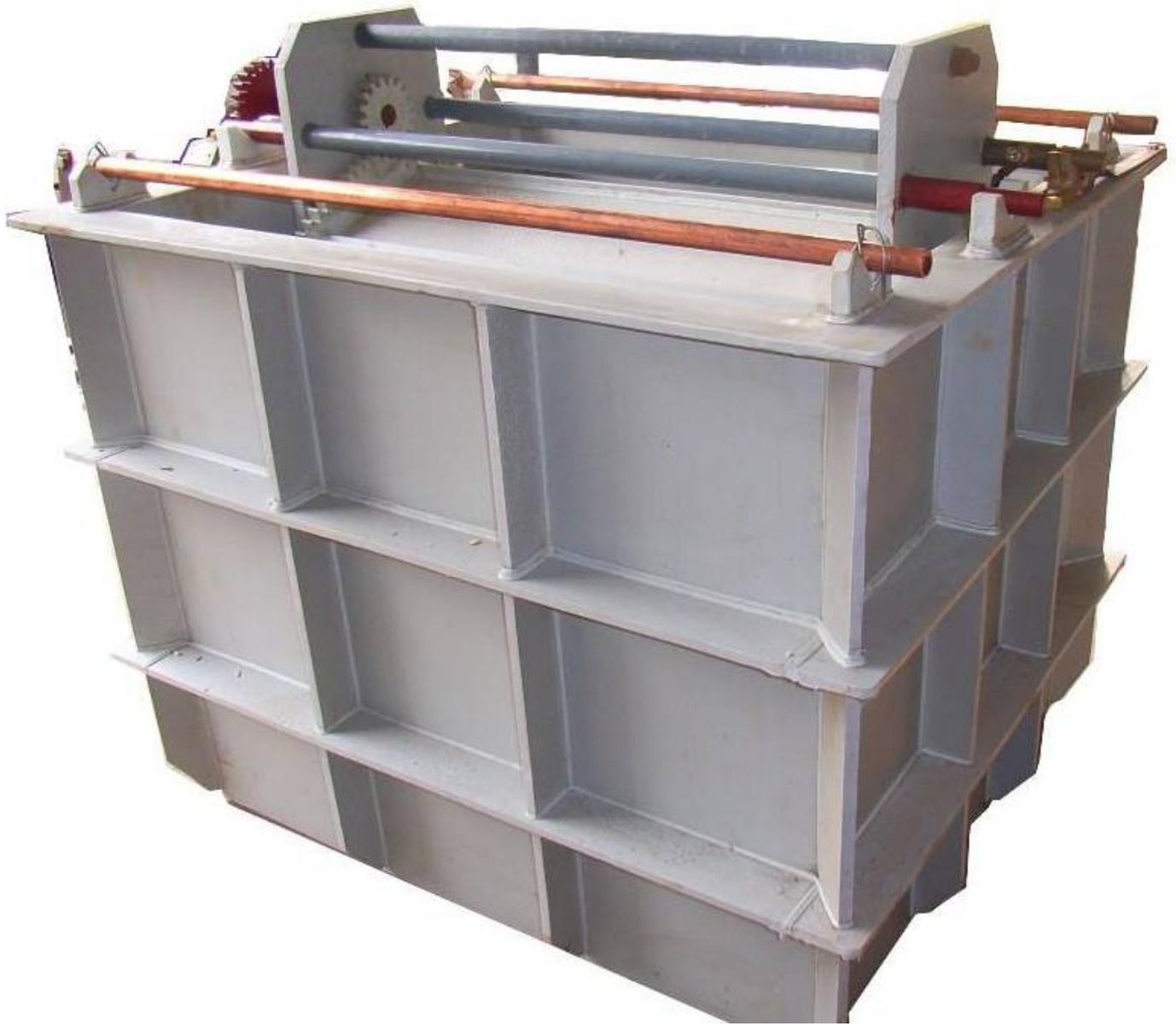
钢衬塑电解槽，顾名思义，是将聚丙烯PP板作为内衬材料，将其包裹在钢壳中。聚丙烯PP板具有出色的防腐性能，不受酸碱等腐蚀介质的侵蚀，因此能够有效延长槽体的使用寿命。同时，聚丙烯PP板具有较高的机械强度，使得钢衬塑电解槽在加工和使用过程中能够承受较高的压力和冲击。
