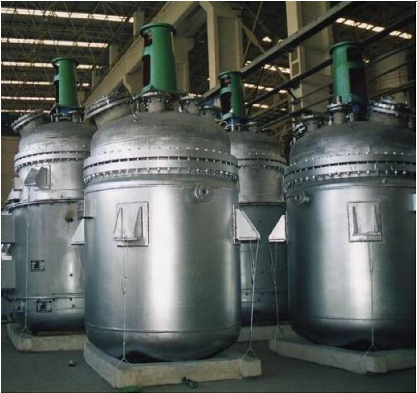
搪玻璃反应釜是另一种常见的反应装置。搪玻璃是将玻璃和金属搪化在一起制成的材料，具有良好的化学稳定性和耐腐蚀性。搪玻璃反应釜不仅具有与不锈钢双层反应釜相似的优点，还具有透明度高、易于观察反应过程的特点。这对于许多需要实时监测反应进程的实验非常重要。搪玻璃反应釜还具有良好的耐温性，可在不同温度条件下进行实验。因此，它是许多科研机构 and 实验室首选的反应装置之一。
