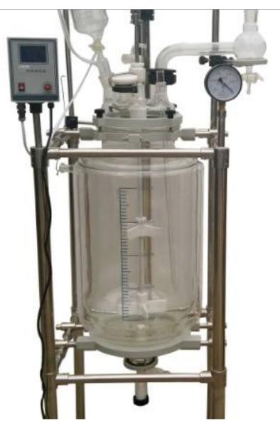
反应器是用于化学反应的容器,通过在容器中加入反应物,进行化学反应过程。搅拌蒸馏反应器和搪瓷反应罐是常见的反应器类型,能够在常压下运行。而高压搪瓷反应釜则专门设计用于在高压环境下进行化学反应。它利用高压状态下反应物的物理和化学性质的改变,实现反应过程的控制和调节。
