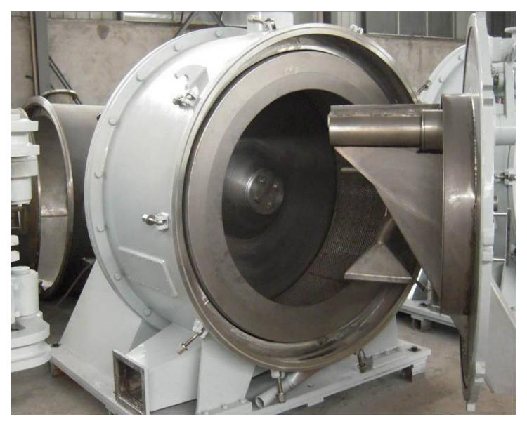
油水啤酒分离机是一种专门用于油水分离的设备,常用于炼油、化工、食品、造纸等领域。该设备通过高速旋转的离心力,将油水两相分离,并有效地去除了油污、悬浮物等杂质。其精确的分离效果,使得产生的废水可以得到有效的处理和回收,达到环保要求。同时,油水啤酒分离机还可应用于啤酒生产过程中的酒花分离工艺,有效提高啤酒的品质和口感。可以说,油水啤酒分离机在工业生产中的应用范围非常广泛,给企业带来了可观的经济效益。
